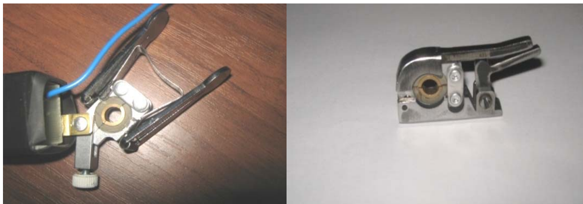
Рис. 4.33. Датчики давления топлива с пружинным и эксцентриковым зажимом
