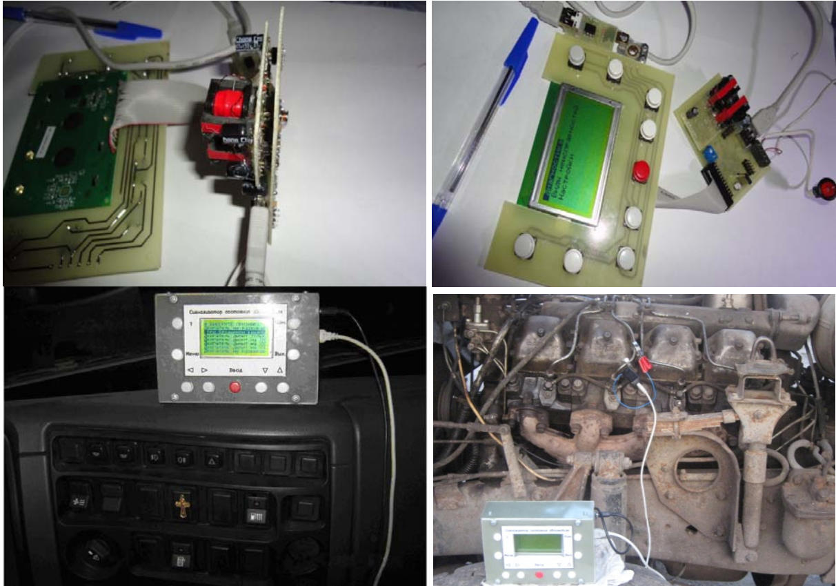
Рис. 4.34. Внутренний и внешний вид встроенной системы диагностирования
