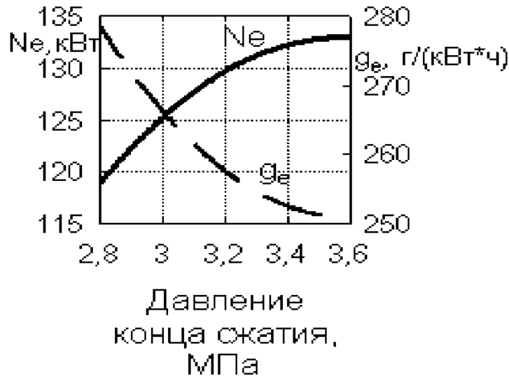
Рис. 1.56. Изменение влияние давления конца сжатия на эффективную мощность и удельный расход топлива
