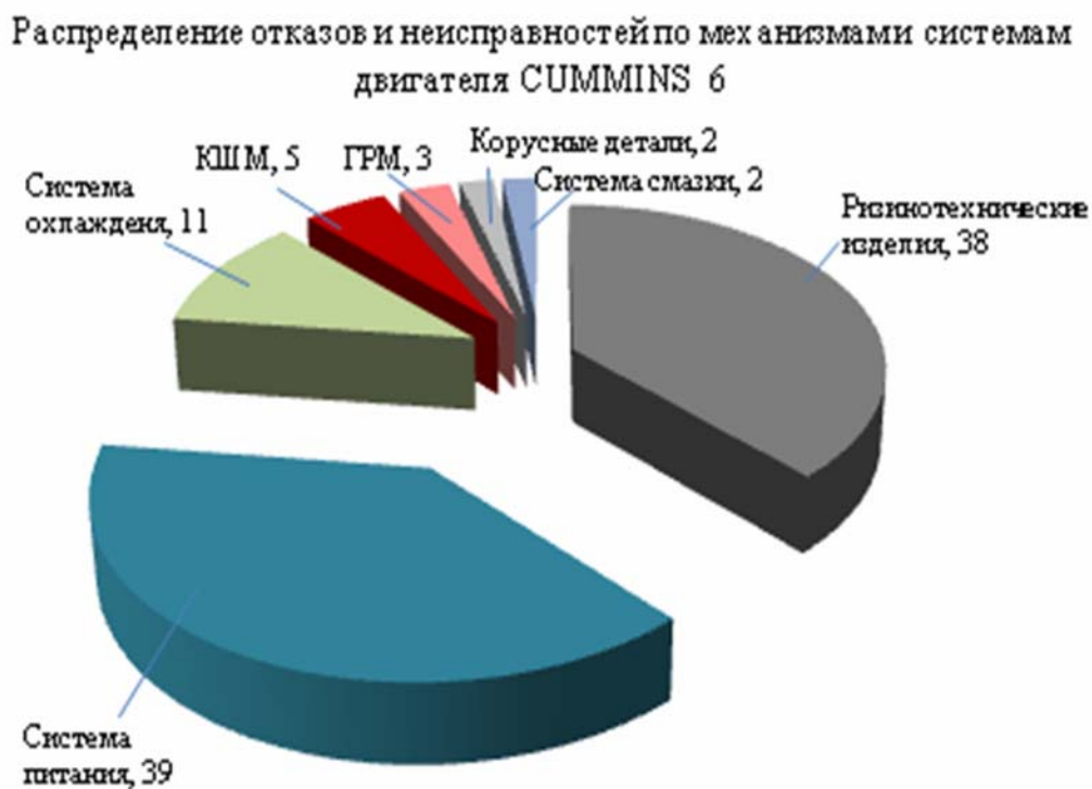
Рис. 1.55. Распределение отказов по механизмам и системам двигателя КАМАЗ
