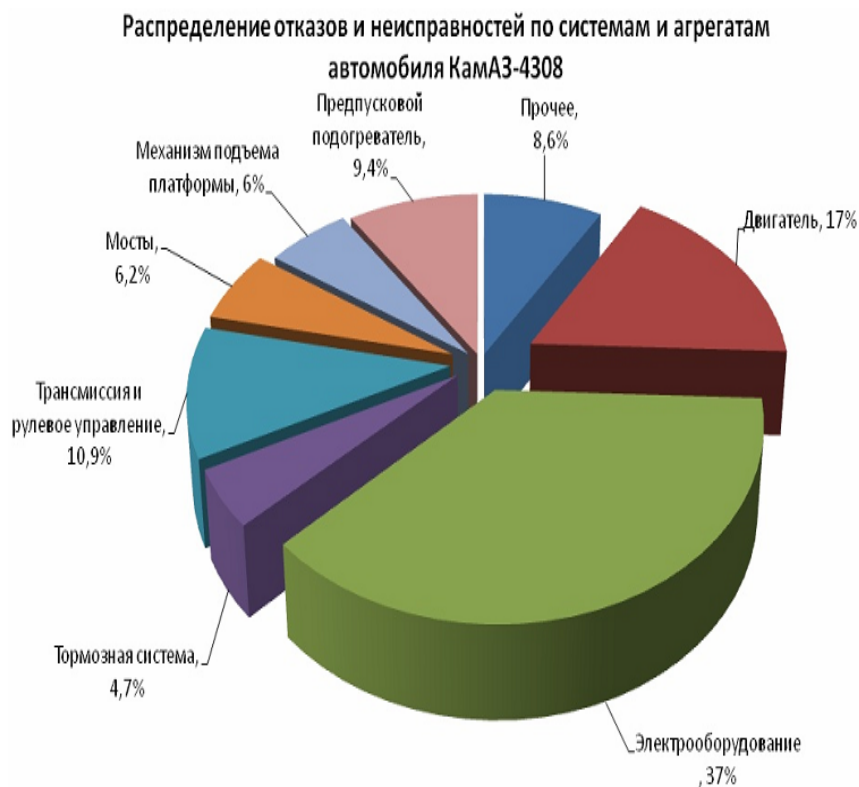
Рис 1.54. Распределение отказов и неисправностей по системам и агрегатам автомобиля КАМАЗ
