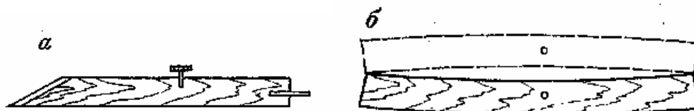
Рис. 7. Линейка: а — поперечный разрез; б — поверка
