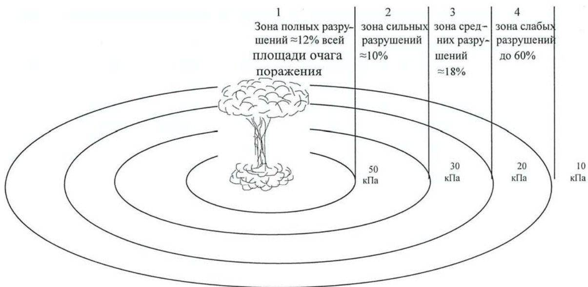
Рис. 21. Деление очага ядерного поражения воздушной ударной волны на зоны
