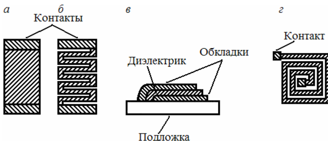
Рис. 1.2. Конфигурация резисторов (а, б), конденсатора (в) и катушки индуктивности (г) в гибридной микросхеме
