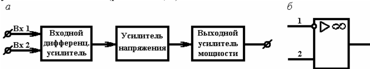
Рис. 3.4.15. Структурная схема интегрального операционного усилителя (а); условное обозначение операционного усилителя (б)
