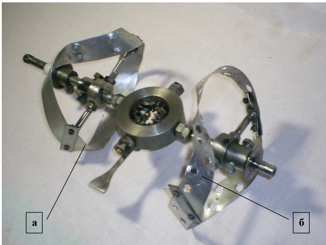
Рис. 3.12. Механизм сбивания с комплектом лент рабочих колес шириной 30 мм: а – без отверстий; б – с отверстиями
