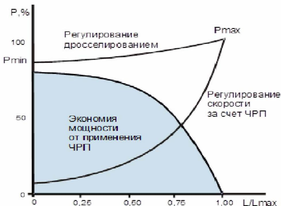
Рис. 56. Зависимость потребляемой мощности от расхода вентилятора (дымососа)
