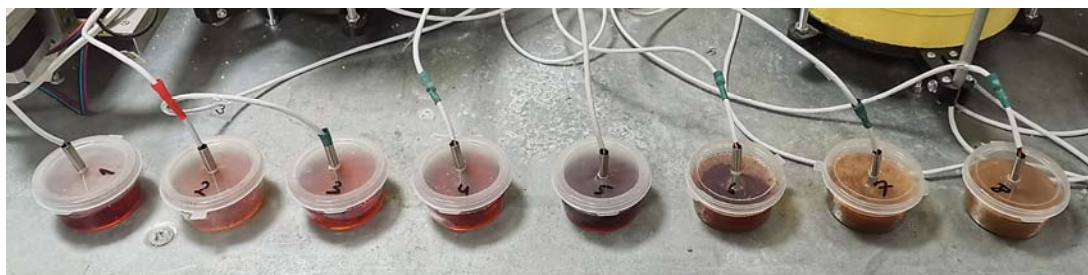
Рис. 7. Термометрия твердеющих эпоксидных композитов
