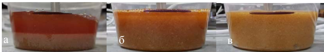
Рис. 14. Расслоение смеси при степени наполнения каменной мукой (мас.): а – 1:1; б – 1:2; в – 1:3
