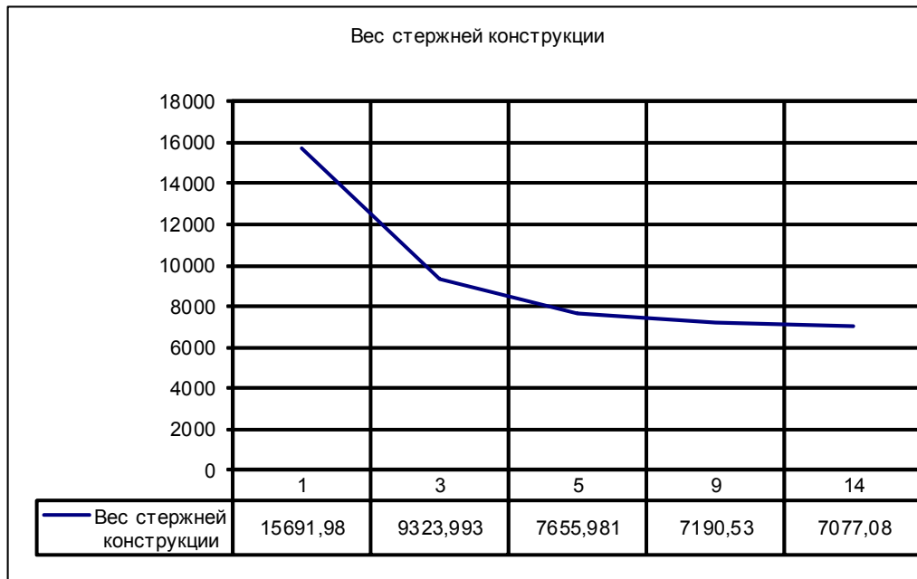
Рис. 6. Зависимости веса элементов стержневой конструкции покрытия (типа «сетка-ромб») от количества используемых типов сечений
