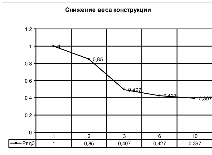
Рис. 9. График зависимости снижения относительного веса конструкции покрытия (типа «соты 6 и 3») по сравнению с использованием одного типа сечения при увеличении количества используемых типов сечений
