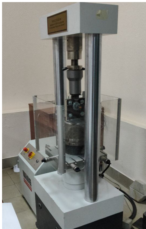
Рис. 3. Испытание образцов: образец в гидравлическом прессе П-500
