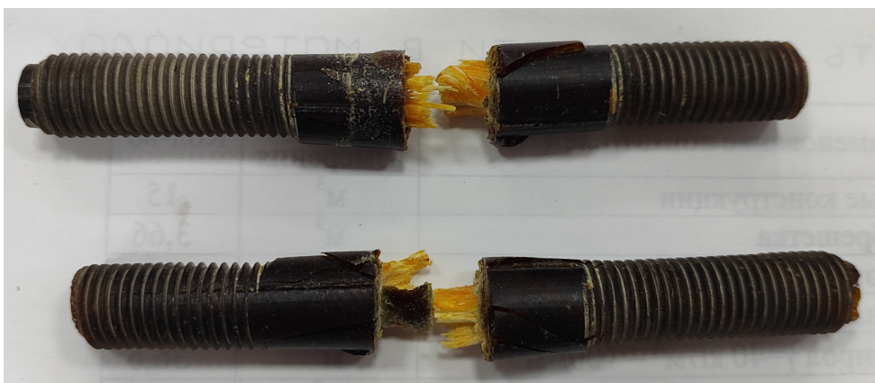
Рис. 5. Общий вид разрушения стеклопластиковых болтов
