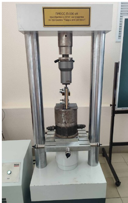
Рис. 3. Испытание образцов: образец в гидравлическом прессе П-500
