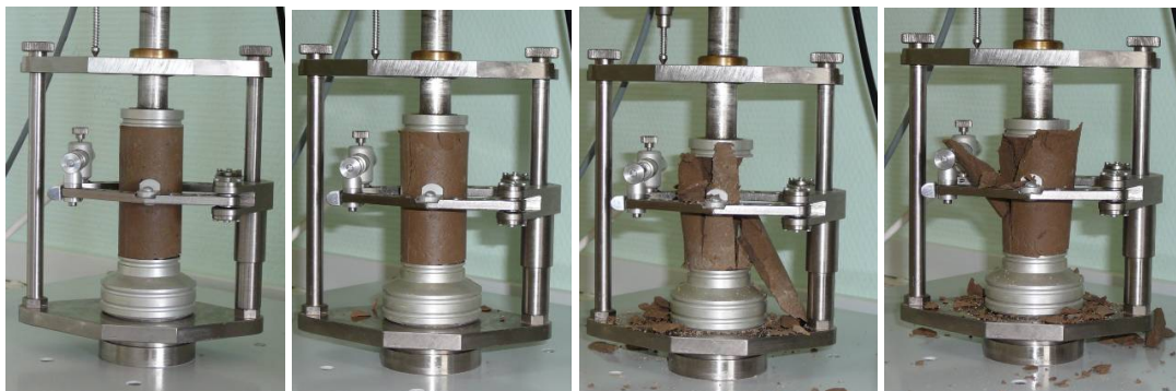
Рис. 7. Форма деформации образца глиношлаковой смеси на различных ступенях осевого нагружения при 10 %-м содержании шлака, 14 суток твердения
