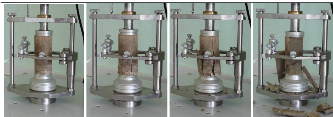
Рис. 12. Форма деформации образца глиношлаковой смеси на различных ступенях осевого нагружения при 20 %-м содержании шлака, 28 суток твердения
