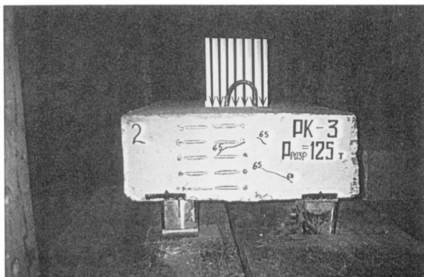
Рис. 2.14. Характер трещинообразования и вид разрушения образца РК-3
