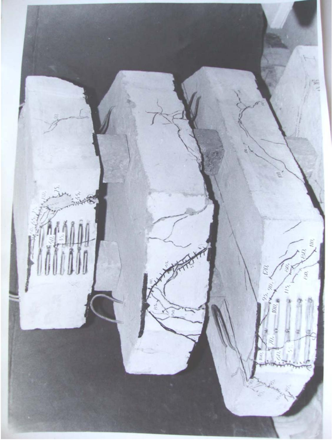
Рис. 1.18. Характер образования трещин и вид разрушения образцов-ростверков с шахматным расположением свай
