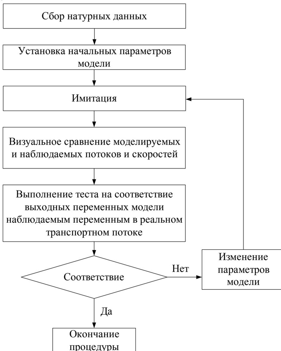
Рис. 6.1. Алгоритм калибровки микроскопических моделей транспортного потока
