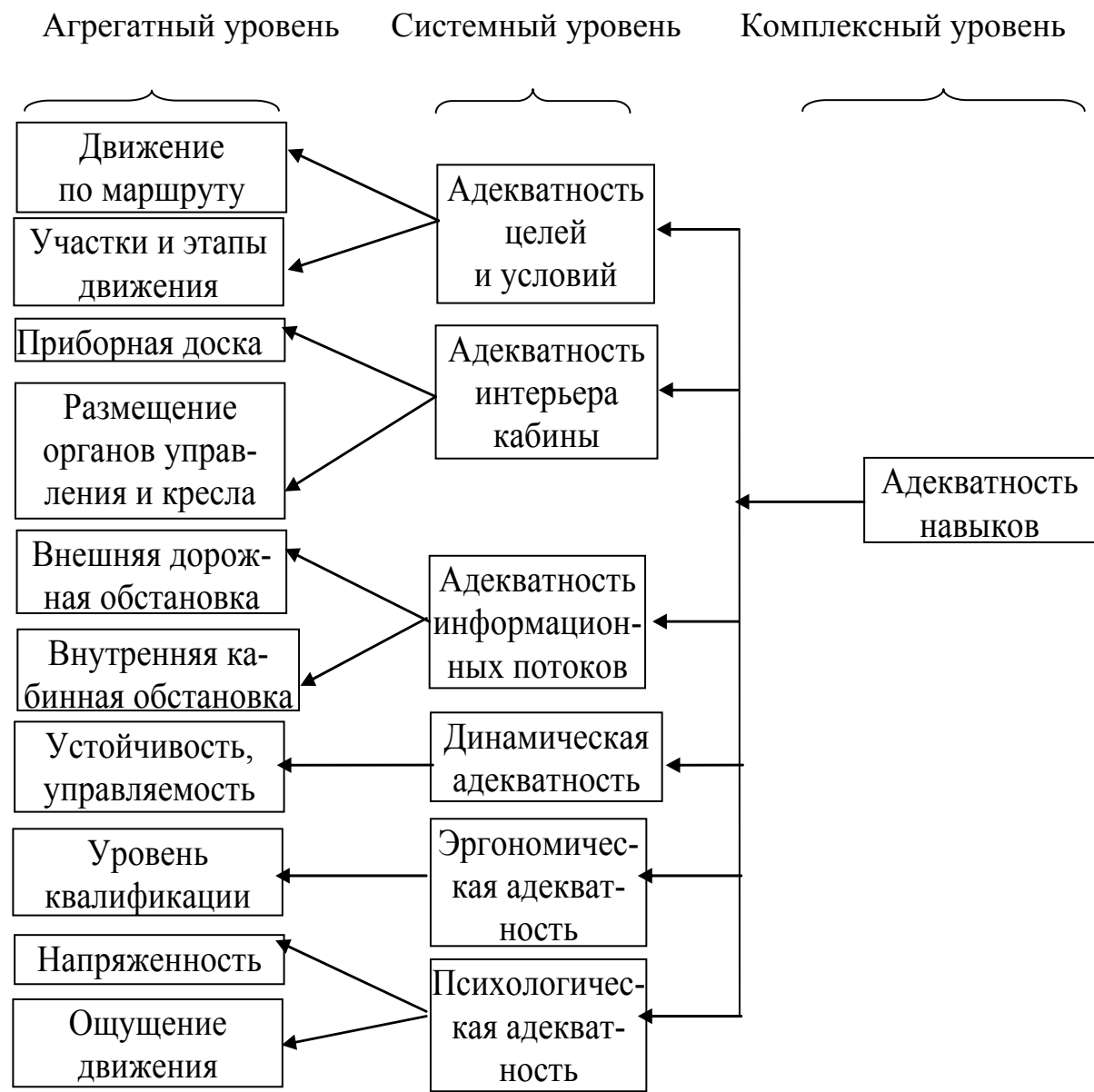
Рис. 2.2. Иерархическая структура адекватности автомобильного тренажера
