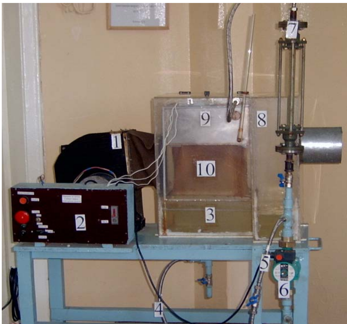
Рис. 4.12. Схема опытной установки контактного аппарата пленочного типа
