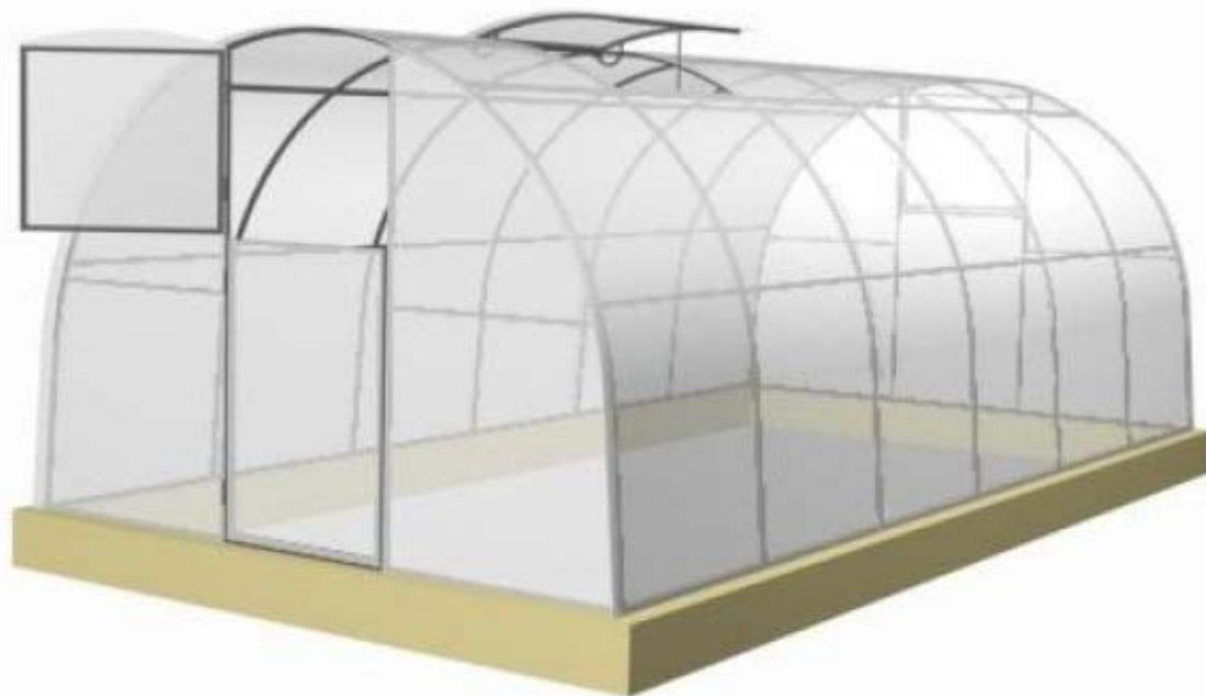
Рис. 2.1. Почвенная теплица арочного типа с ленточным цоколем
