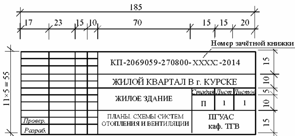
Рис. 55. Основная надпись на строительных чертежах
