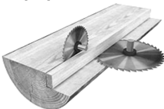
Рис. 68. Принцип распиловки способом углового пиления
