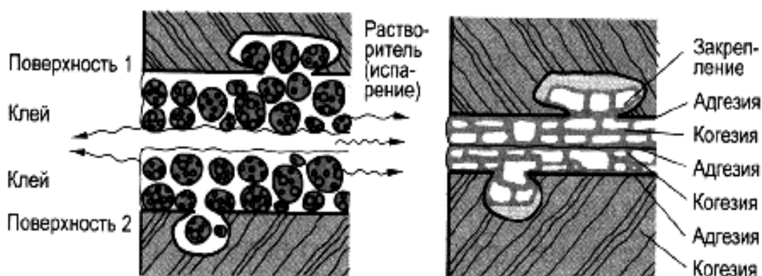
Рис. 33. Стык, выполненный клеем на основе растворителя [12]
