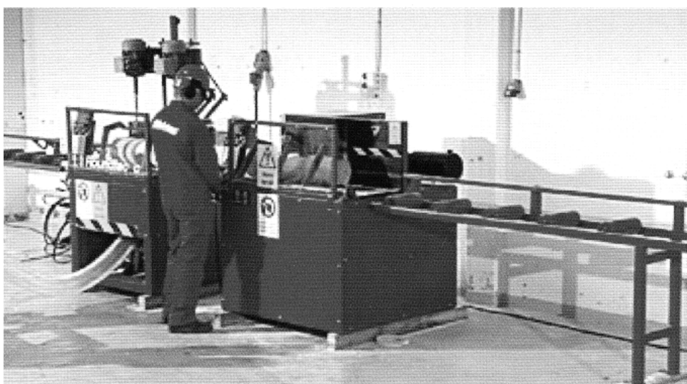
Рис. 78. Оцилиндровочный станок проходного типа ( Roundec-Combi-Jumbo 600 )
