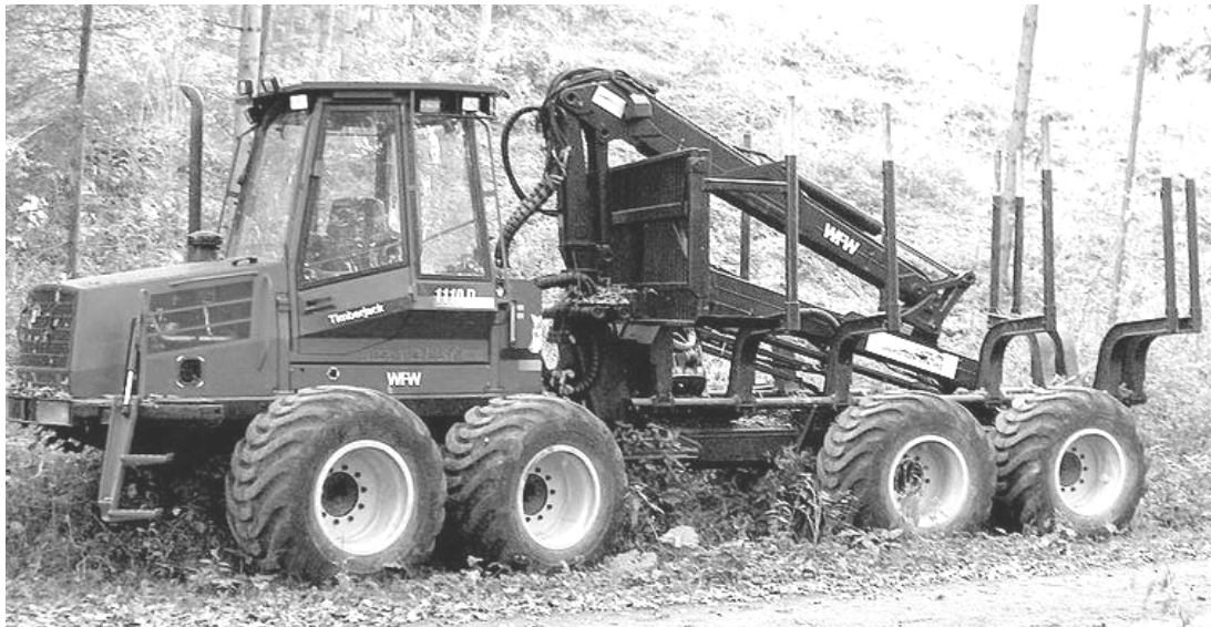
Рис. 37. Форвардер – самоходная двухмодульная машина, состоящая из погрузочного манипулятора и грузовой тележки
