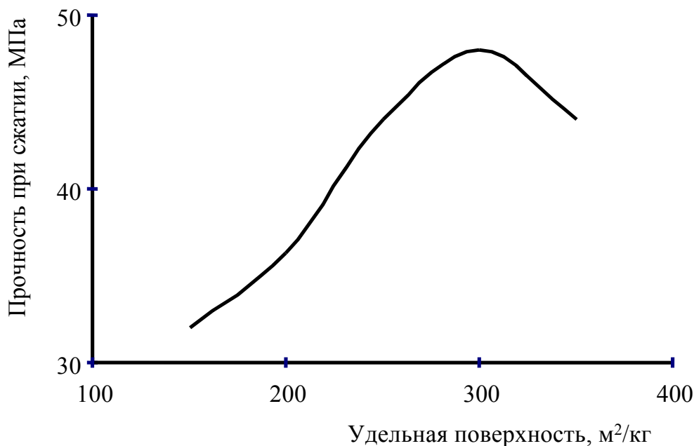
Рис. 1.9. Зависимость прочности ССМ от удельной поверхности золы [107]
