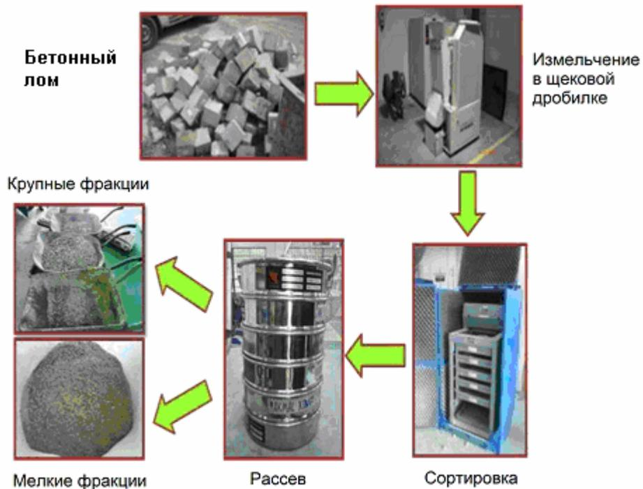
Рис. 1.13. Схема производства геополимерного бетона при использовании лома бетонных конструкций
