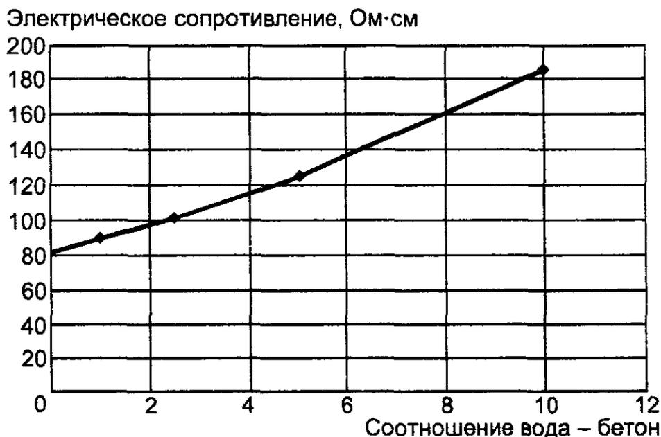
Рис. 3.7. Оценка электрического сопротивления водной вытяжки из бетона
