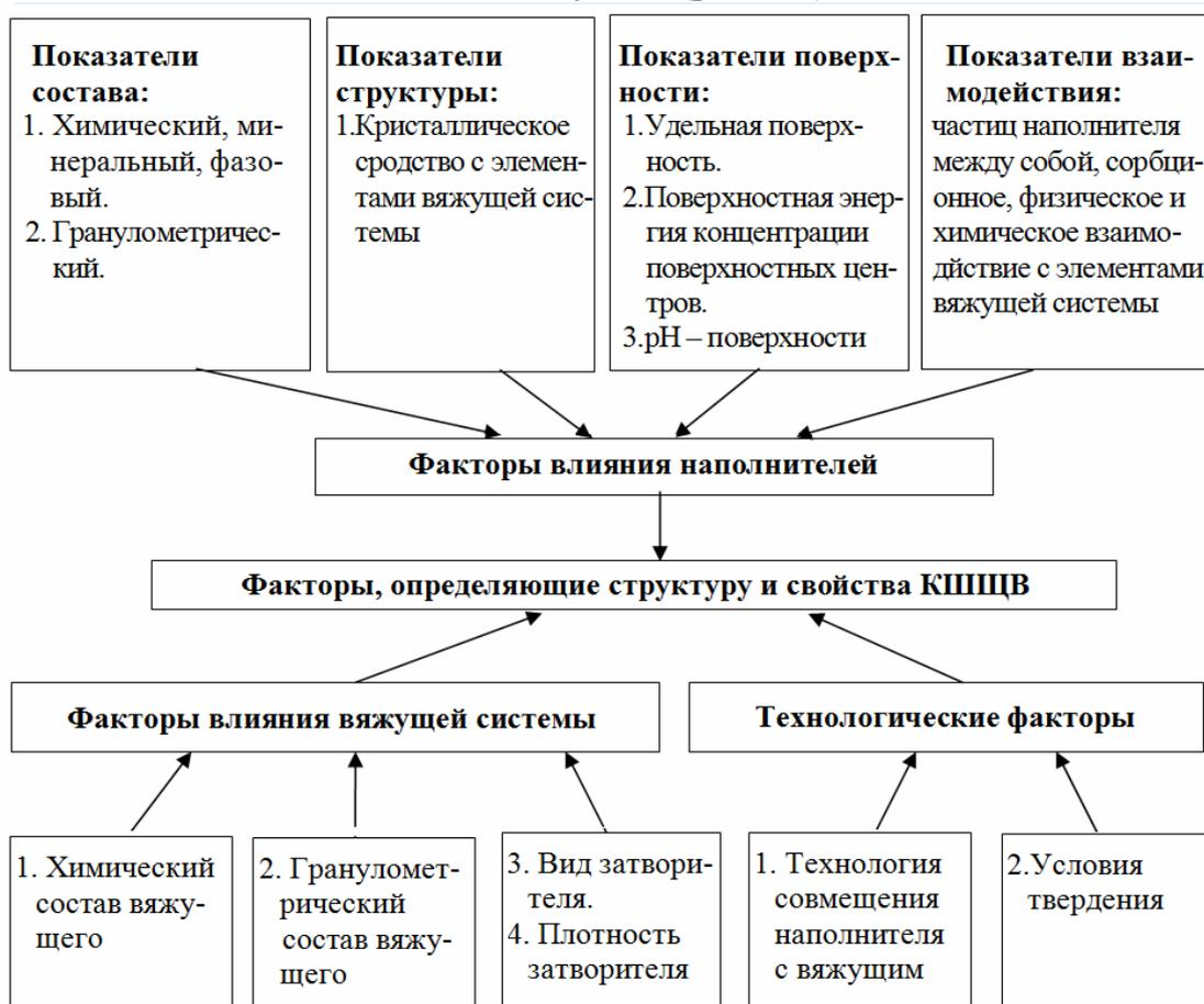
Рис. 2.2. Система факторов, определяющих структуру и свойства композиционных шлакощелочных вяжущих, по данным Н.Р. Рахимовой
