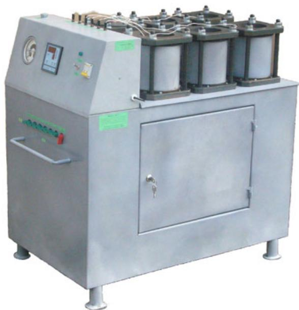
Рис. 3.2. Установка для определения водонепроницаемости по методу «мокрого пятна»
