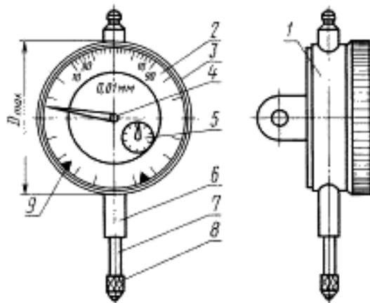
Рис.8. Индикатор часового типа марки ИЧ-10 с перемещением измерительного стержня параллельно шкале:
