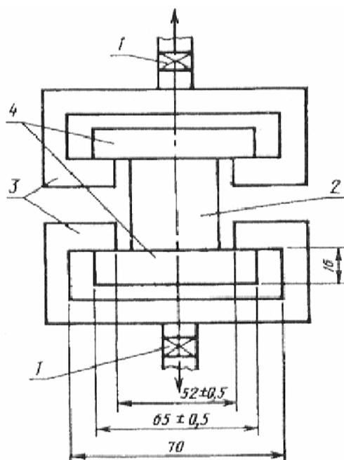
Рис.10. Схема испытания прочности при растяжении перпендикулярно к пласти цементно-стружечной плиты:
