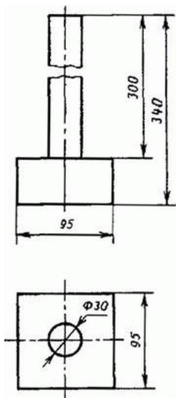
Рис.2. Приспособление для трамбования арболитовой смеси (стальная болванка)
