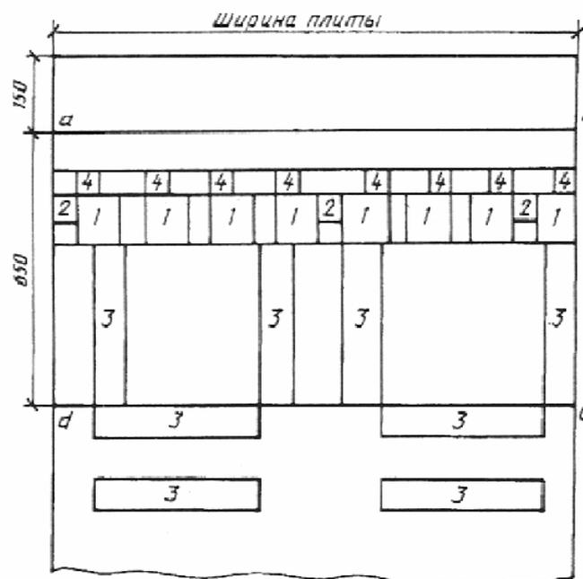
Рис.6. Схемы отбора образцов из плиты для испытаний:
