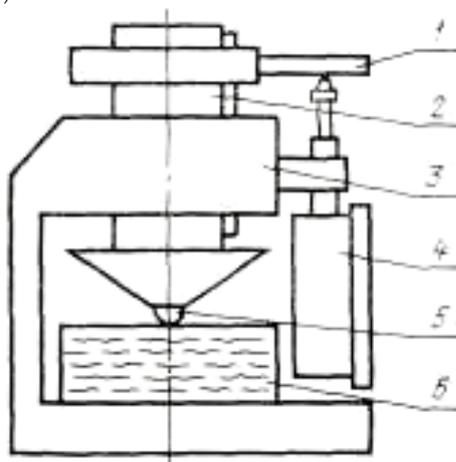
Рис.11. Схема испытания твердости ЦСП:
