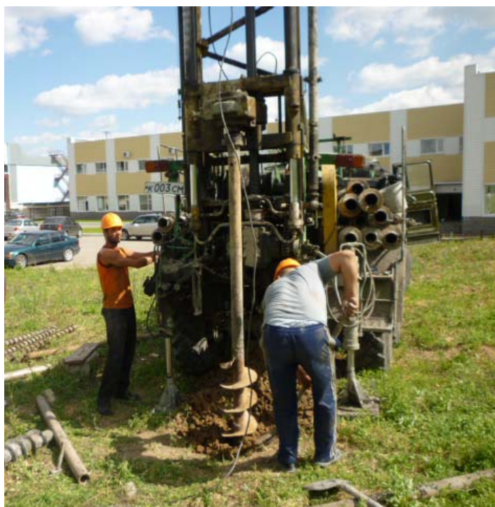
Рис. 3.9. Бурение скважины шнеком для отбора монолитов глины
