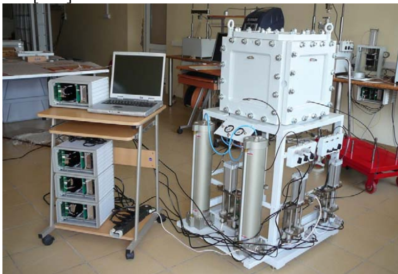
Рис. 2.19. Общий вид прибора истинного трехосного сжатия (Патент № 94341 [41])
