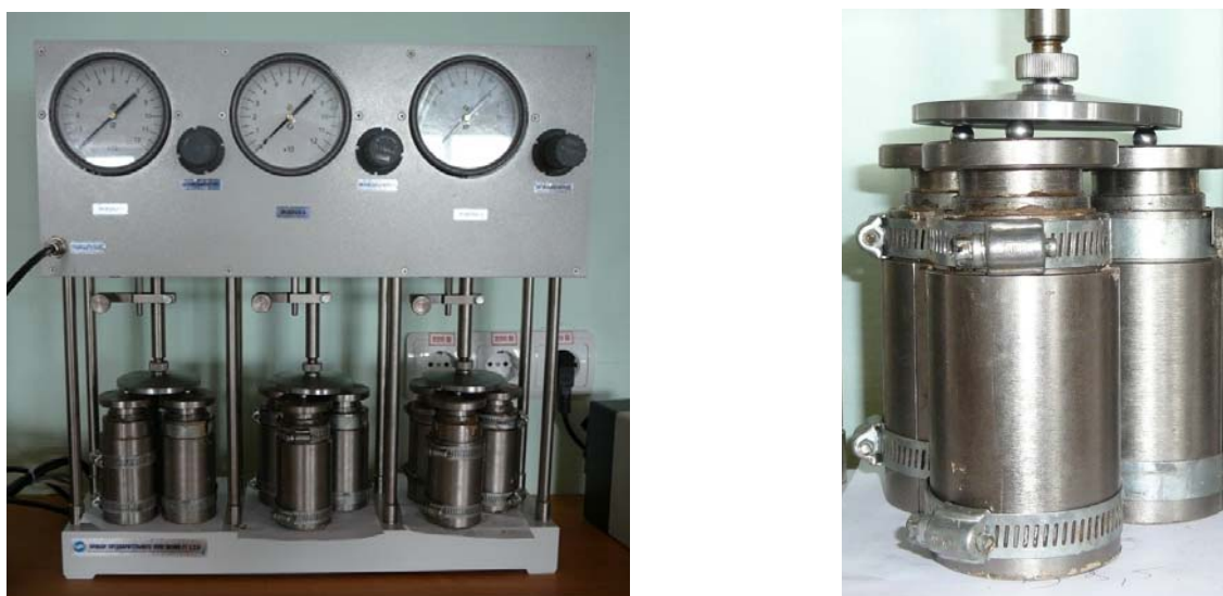
Рис. 3.8. Устройство для уплотнения образцов в процессе их твердения
