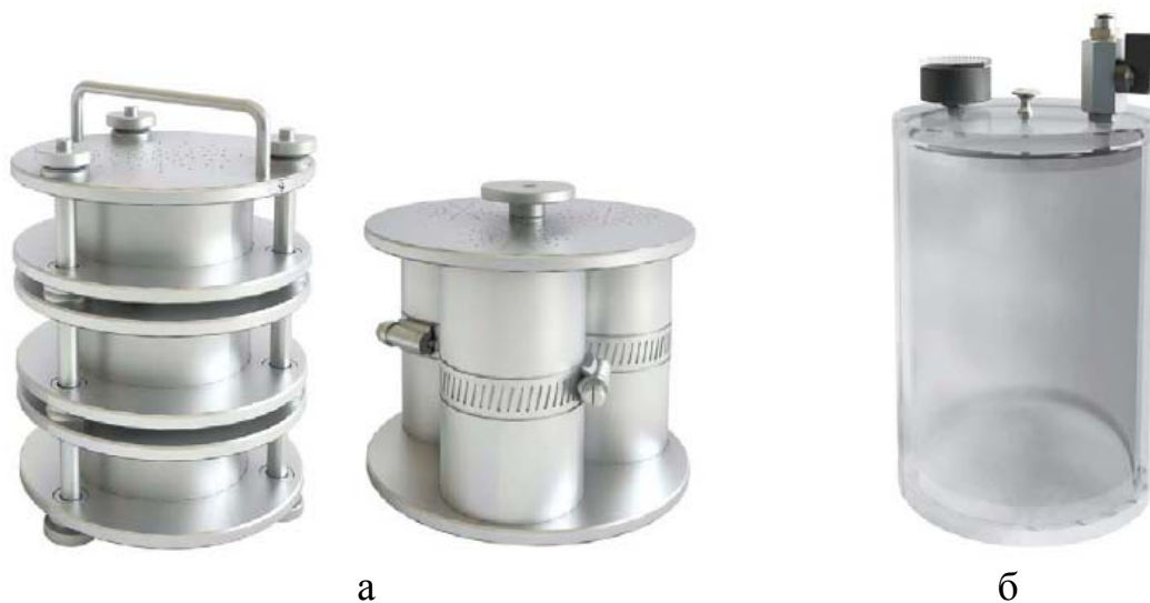
Рис. 3.4. Устройство для замачивания образцов материалов: а – набор колец для цилиндрических образцов различной высоты и диаметра; б – вакуумная камера
