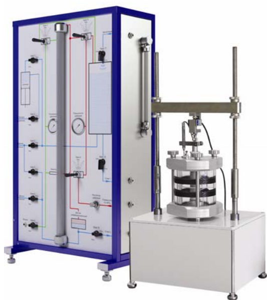
Рис. 2.13. Прибор трехосного сжатия (патенты № 85167, 64648 [39,40])
