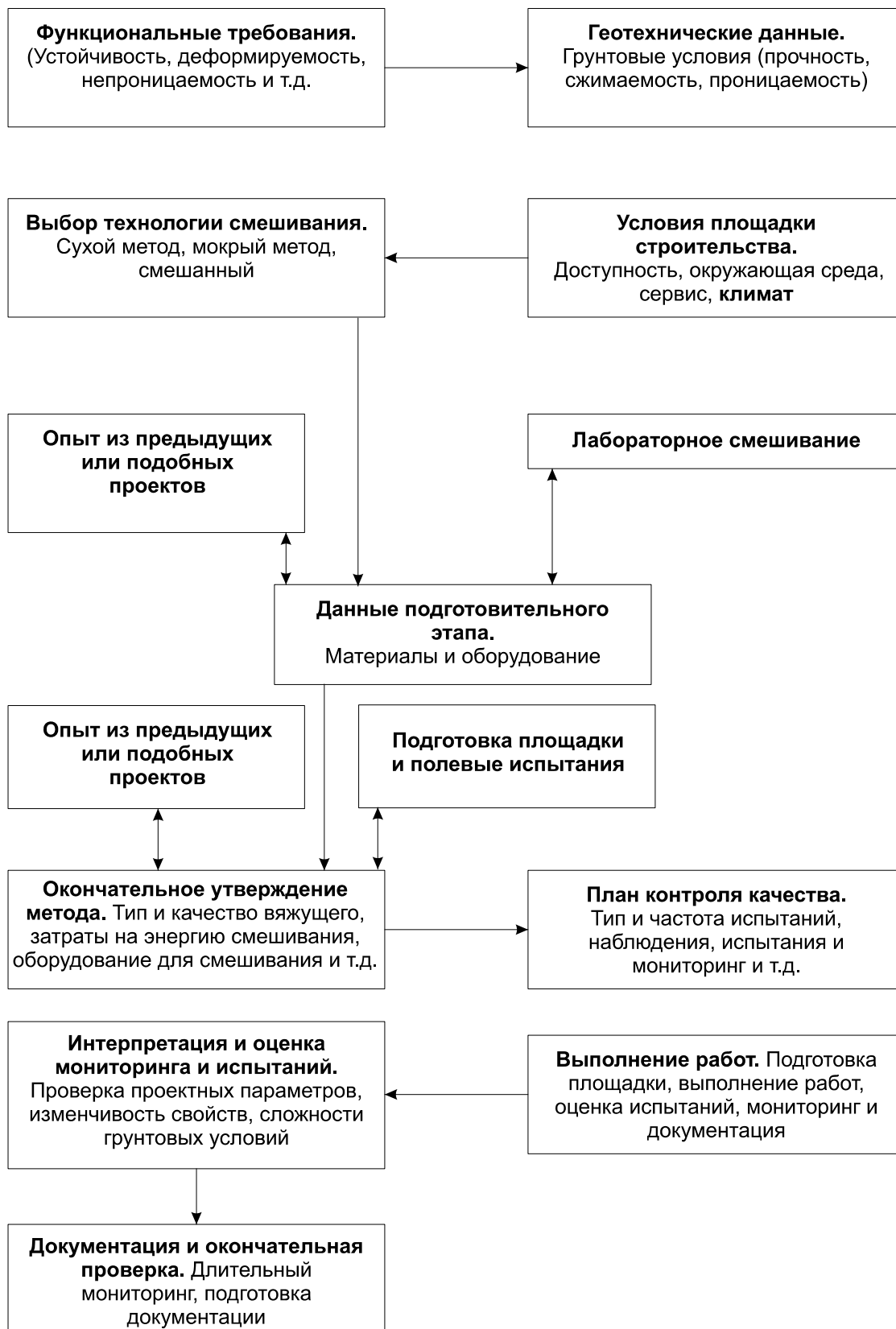
Рис. 5.5. Принципы выполнения глубинного смешивания [79]
