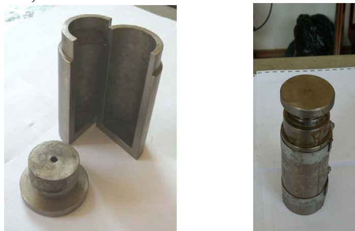
Рис. 3.6. Разъемная форма для изготовления цилиндрических образцов
