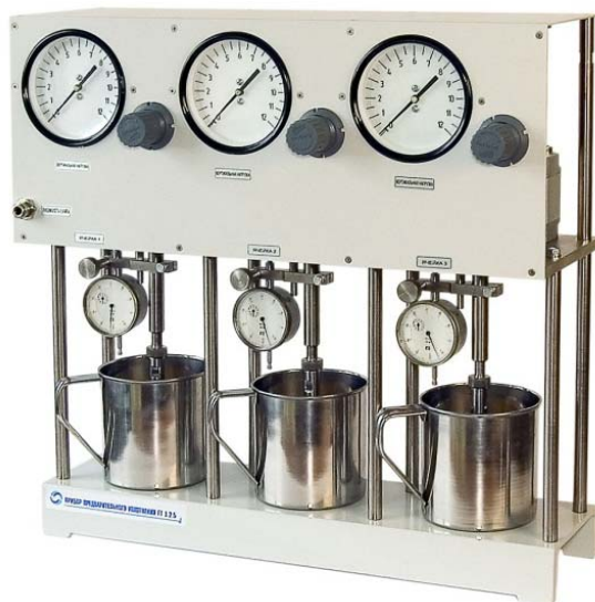
Рис. 3.3. Устройство для выдержки образцов во времени под заданным нормальным давлением (Патент 70316 [45])
