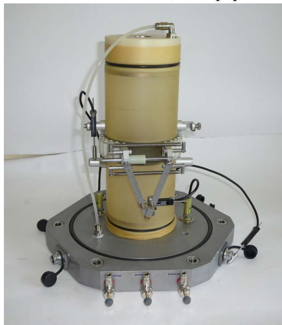
Рис. 2.7. Измерение осевой и радиальной деформации в центральной части образца
