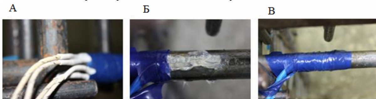
Рис. 3.8. Последовательность гидроизоляции тензорезисторов: А – вид проводов, обжатых термоусадочной трубкой; Б – вид датчика, обработанного силиконовым герметиком; В – вид датчика, защищённого изоляционной лентой
