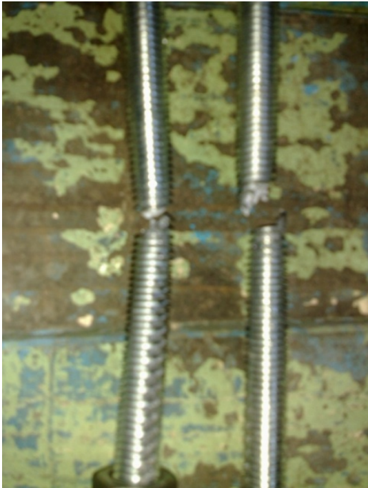
Рис. 3.6. Вид шпилек после разрыва
