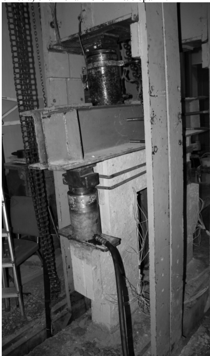
Рис. 3.11. Вид испытательного стенда сбоку консоли колонны
