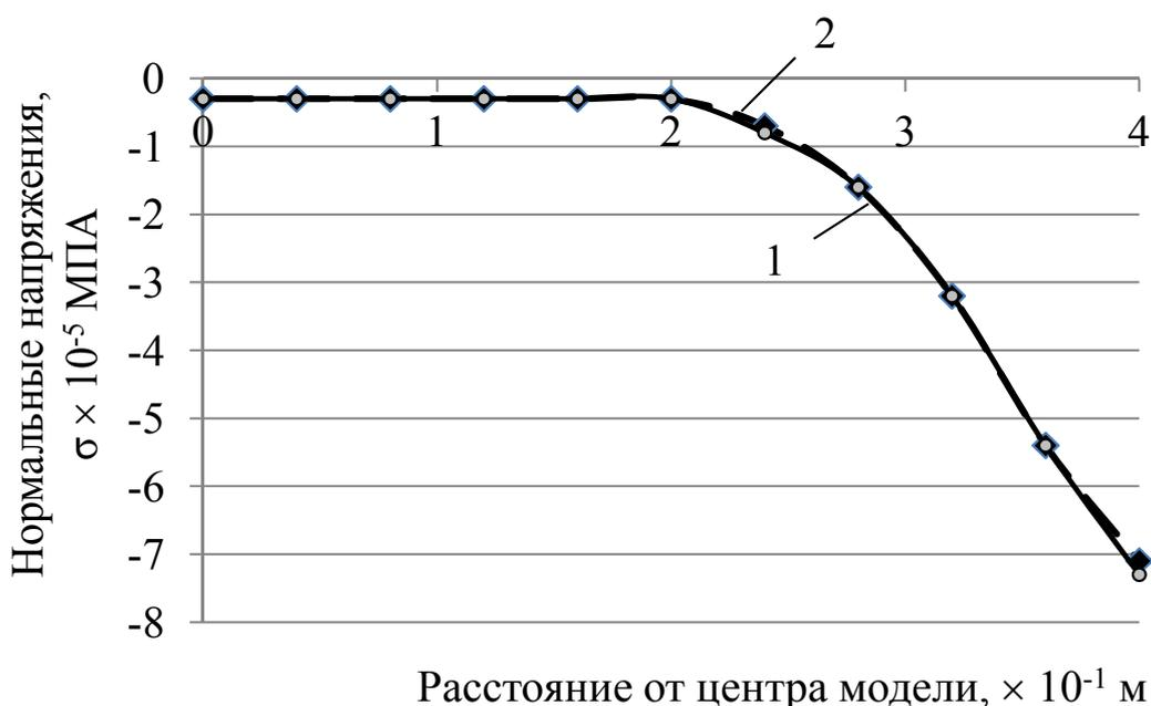
Рис. 4.7. Нормальные напряжения в зоне контакта штукатурки с отделываемым покрытием по линии 1-7:
