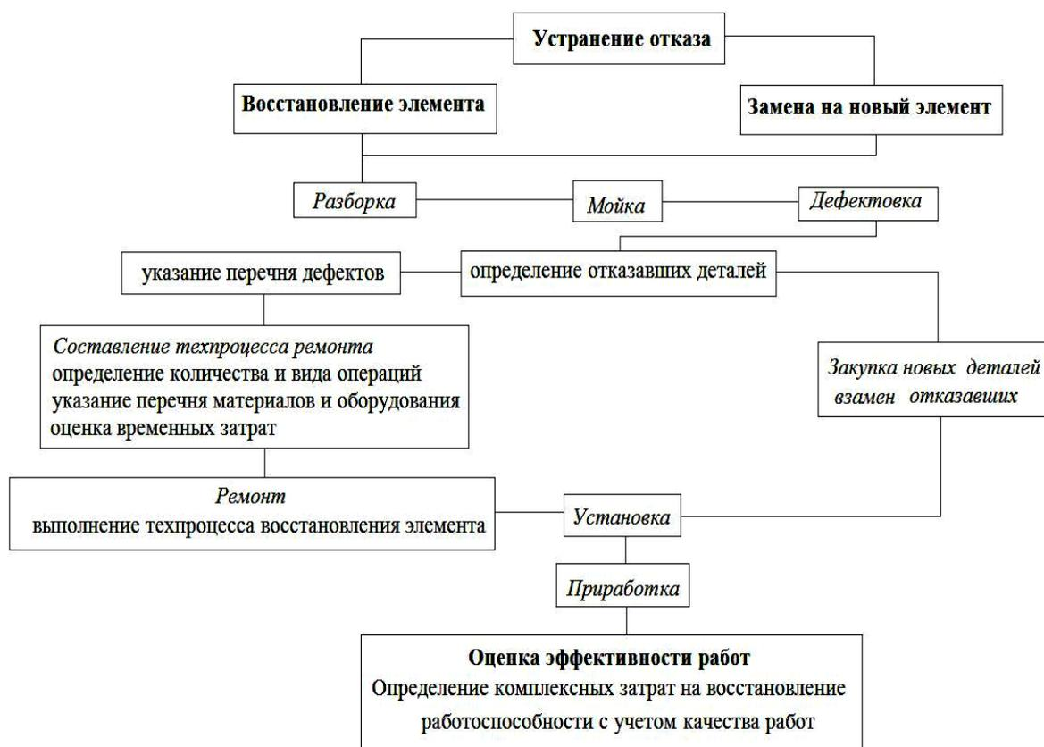
Рис. 7.13. Схемы путей устранения отказов [11]
