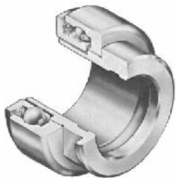
Рис. 2.20. Муфта выключения сцепления с упорным шариковым подшипником: а – с проточкой в корпусе; б – с соединительной пружиной (автомобили ВАЗ); 1 – муфта; 2 – вилка; 3 – рычаги механизма выключения сцепления; 4 – направляющая втулка; 5 – первичный вал коробки передач
