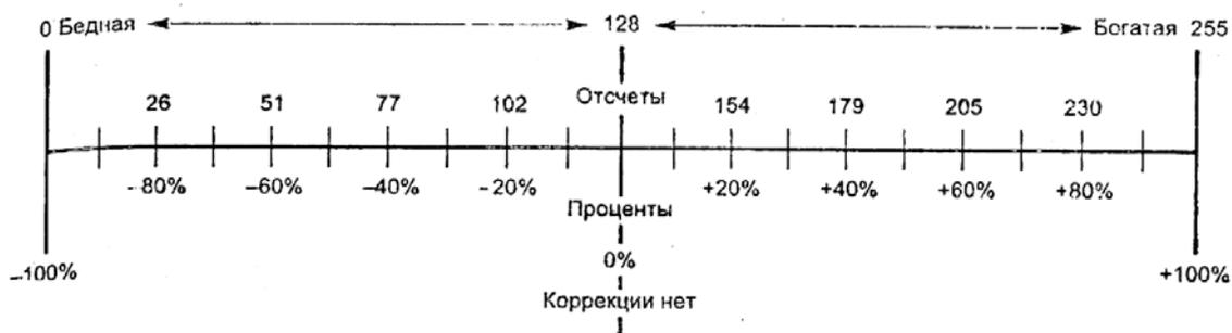
Рис. 1.21. Шкала коэффициентов топливокоррекции
