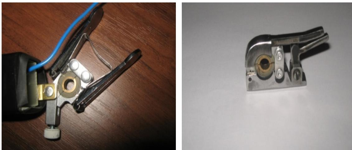
Рис. 2.32. Датчики давления топлива с пружинным и эксцентриковым зажимами
