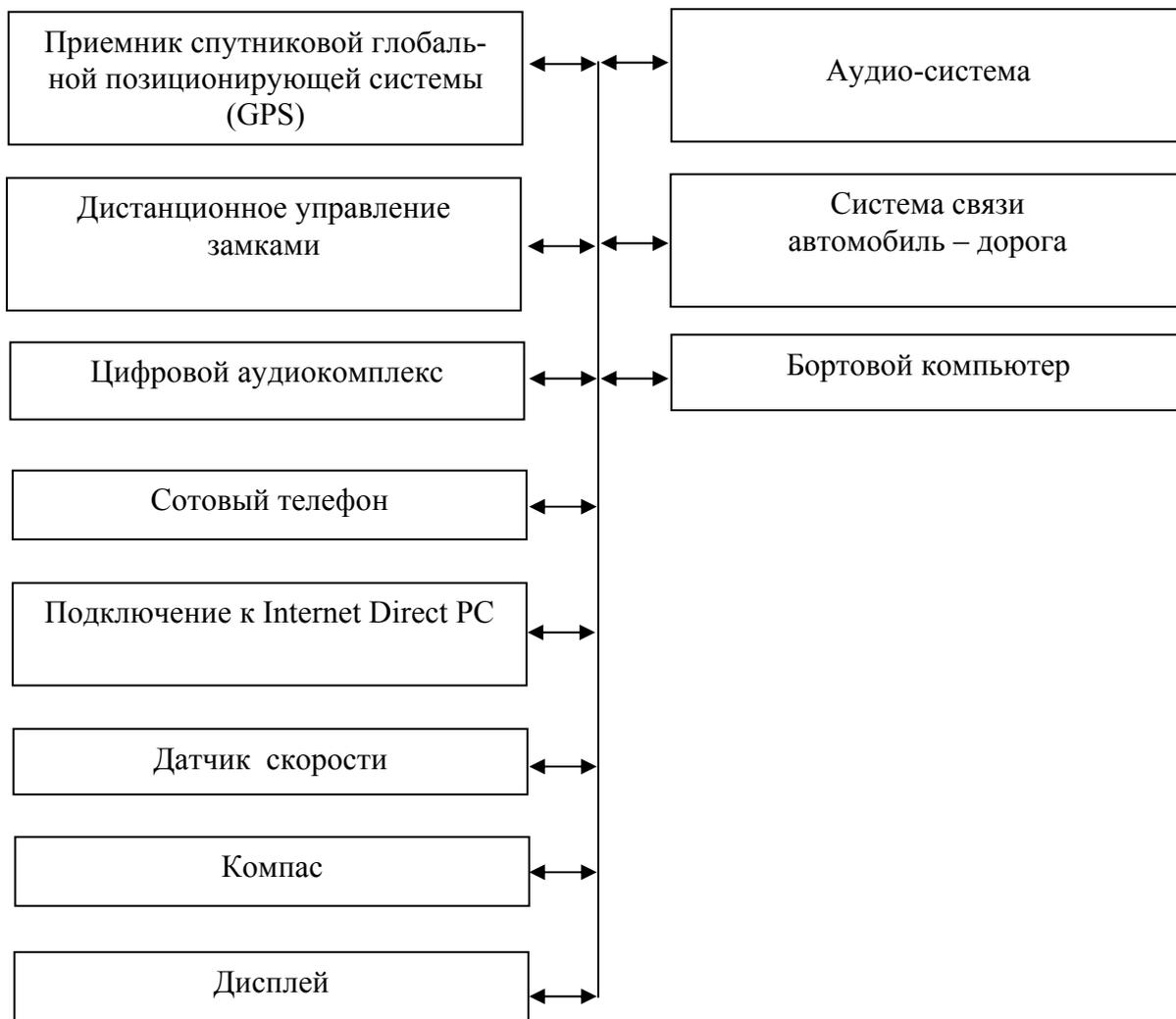
Рис. 1.10. Блок-схема информационной системы водителя
