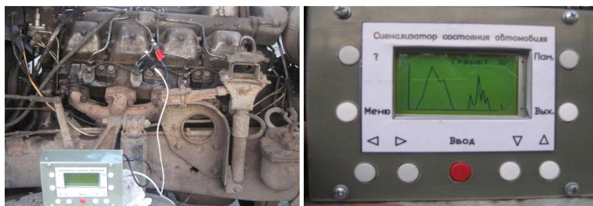
Рис. 2.33. Внутренний и внешний вид встроенной системы диагностирования
