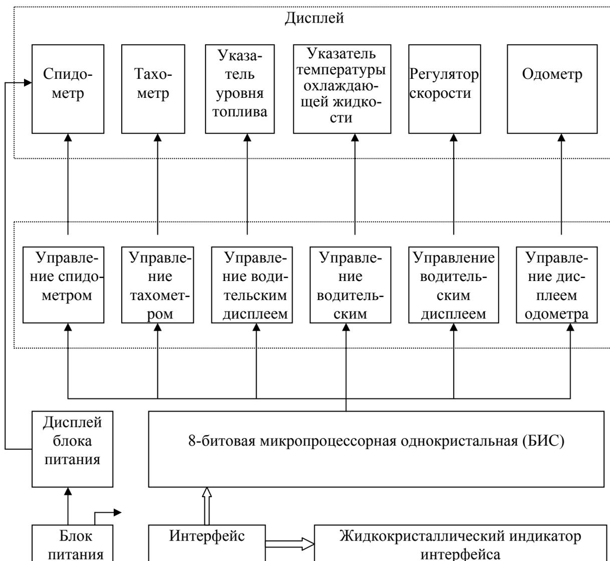
Рис. 1.4. Блок-схема микропроцессорной приборной панели автомобиля «Soare»
