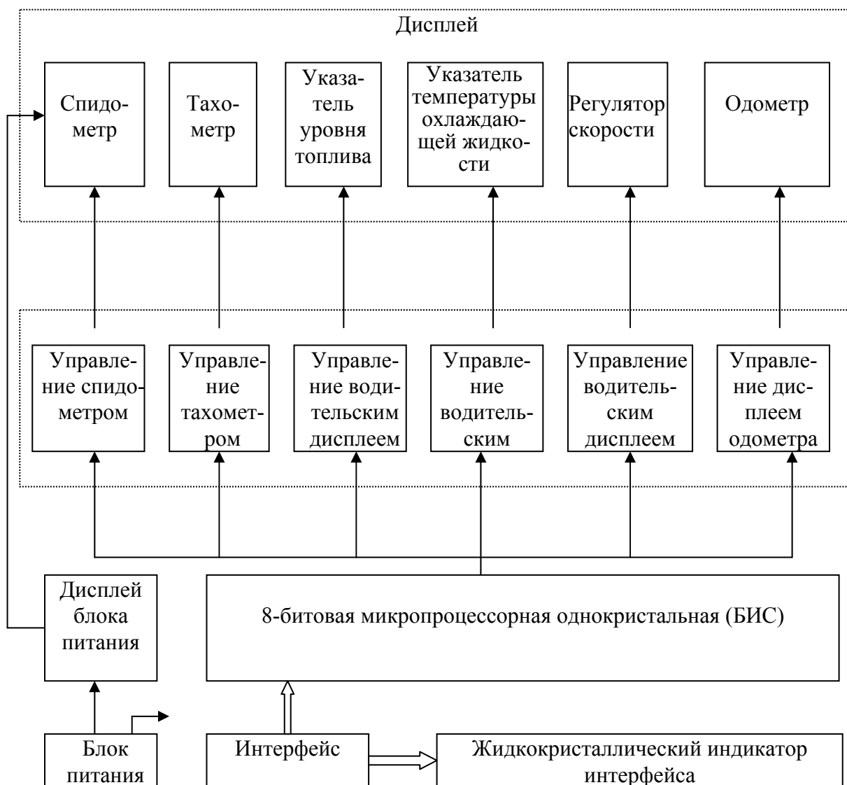
Рис. 1.4. Блок-схема микропроцессорной приборной панели автомобиля «Soare»
