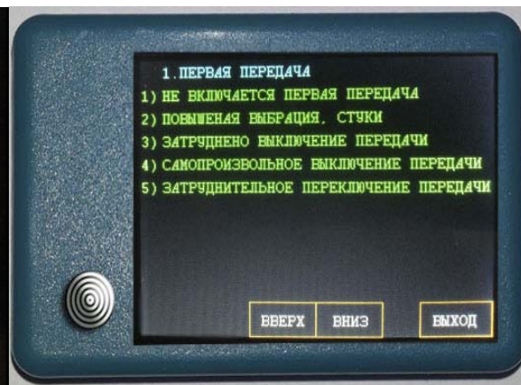
Рис. 2.75. Встроенная система диагностирования: а – корпус встроенной системы диагностирования; б – датчик температуры главной передачи; в – текущие показания датчиков; г – опросная часть встроенной системы диагностирования
