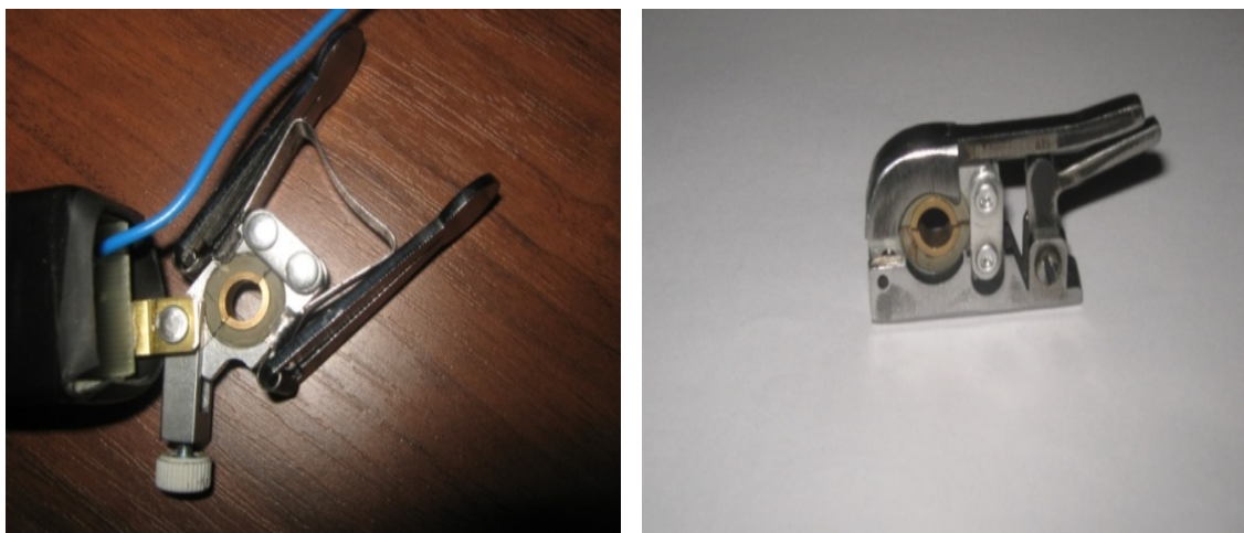
Рис. 2.32. Датчики давления топлива с пружинным и эксцентриковым зажимом
