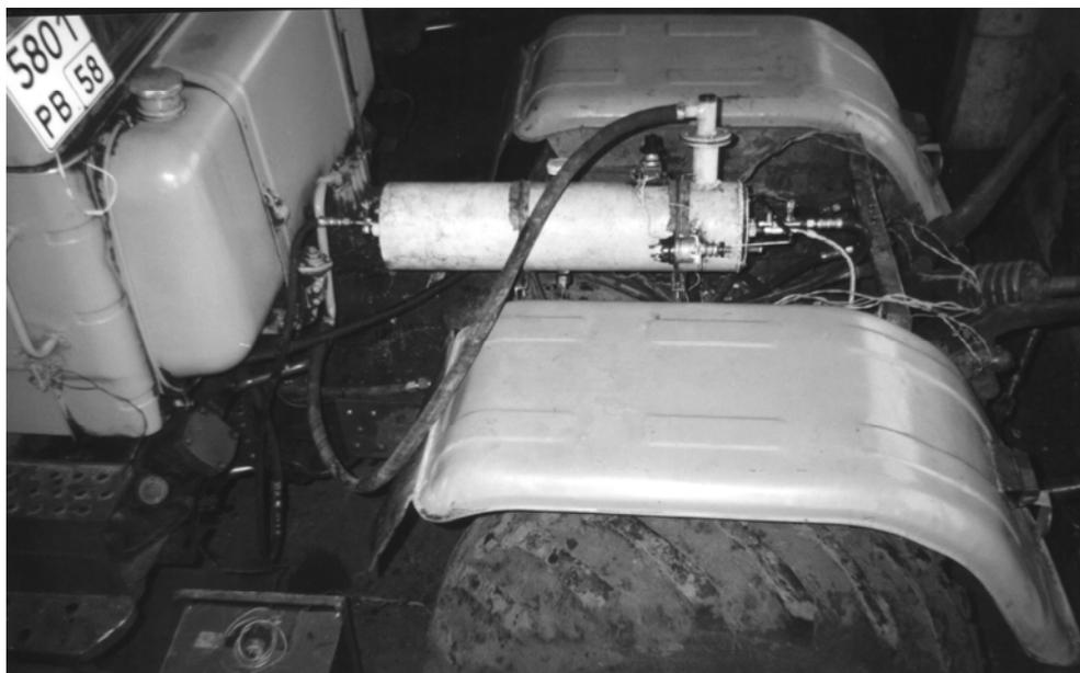
Рис. 3.11. Общий вид трактора Т-150К с установленной системой терморегулирования
