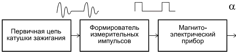
Рис. 5.15. Структурная схема электронного тахометра
