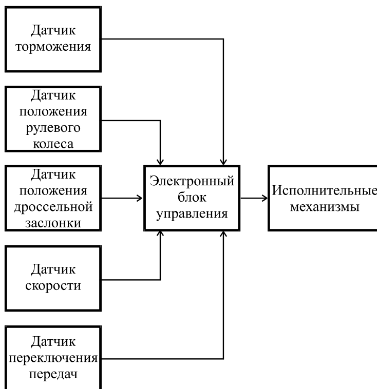
Рис. 6.59. Структурная схема электронной системы автоматического управления подвеской
