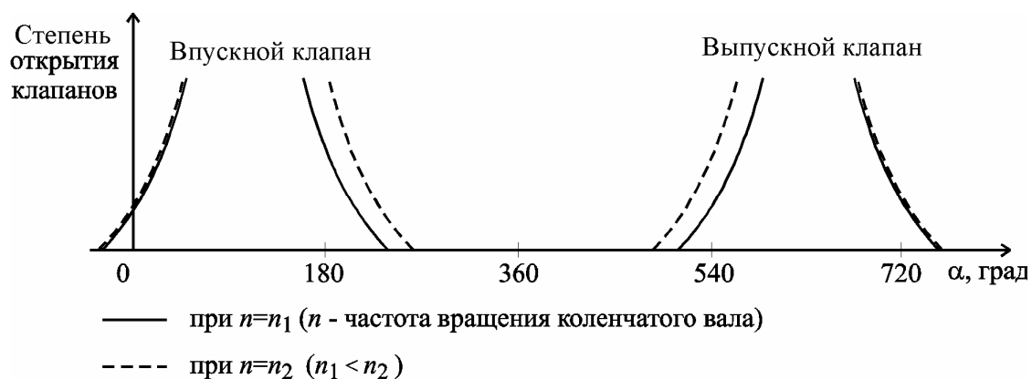
Рис. 6.57. Зависимости оптимальной степени открытия впускного и выпускного клапанов от угла поворота коленчатого вала
