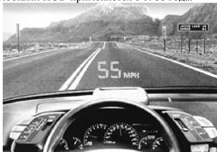
Рис. 5.28. Вид через ветровое стекло автомобиля с HUD. Модель Pontiac Bonneville SSEi
