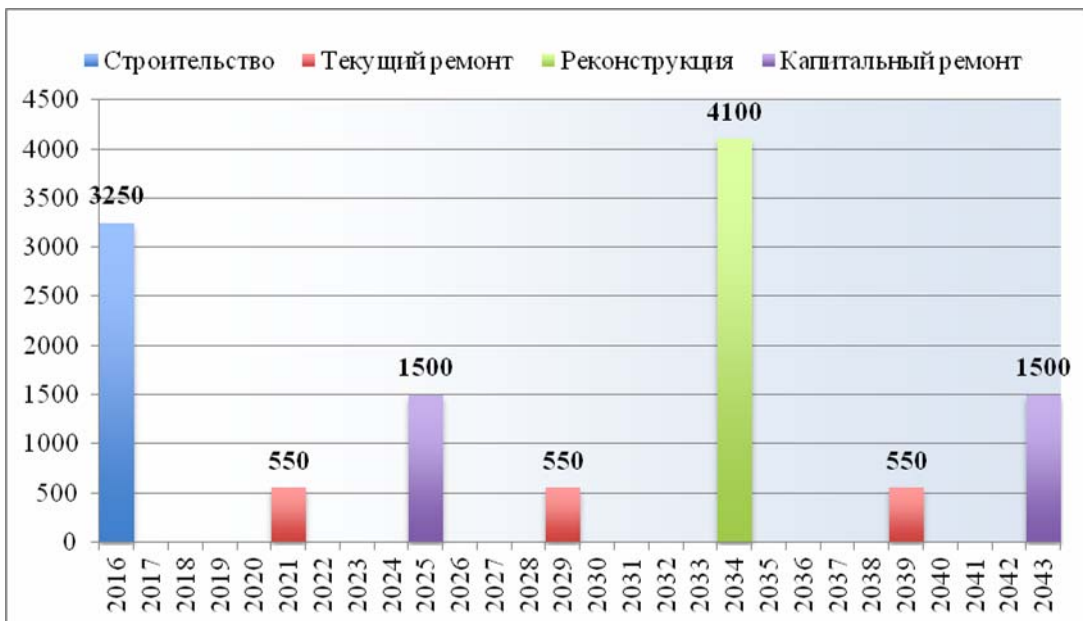
Рис. 1.7. График расходов по созданию и содержанию 1 м 2 дороги по российской технологии (редкие ремонты), в ценах на 2013 год, руб./м 2 (Российская технология с низкой периодичностью ремонтов)
