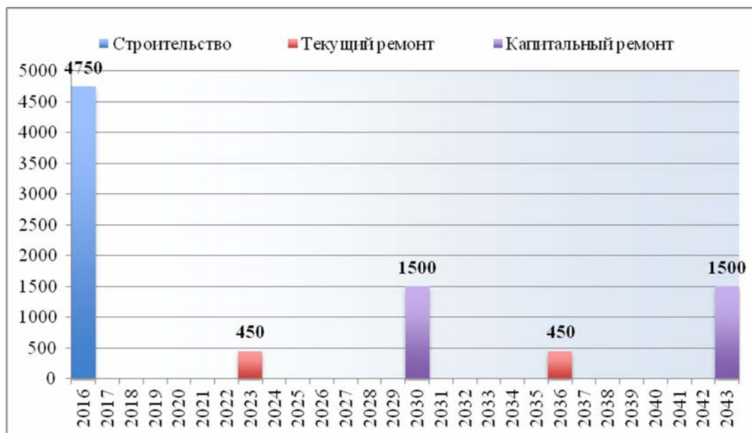
Рис. 1.8. График расходов по созданию и содержанию 1 м 2 дороги по немецкой технологии, в ценах на 2013 год, руб./м 2 (Немецкая технология с применением КЖЦ)
