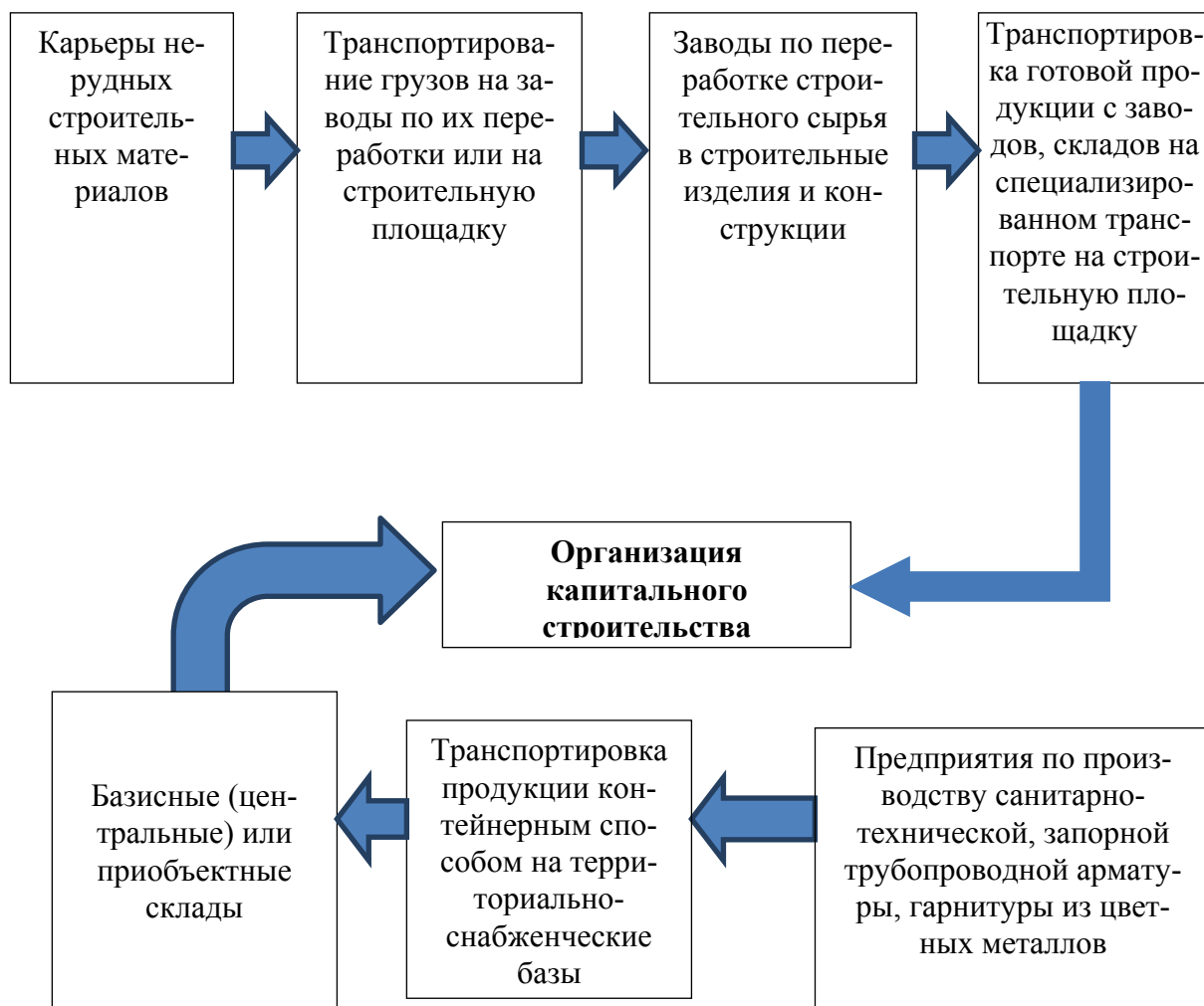
Рис. 2.2 Модель транспортировки строительных грузов
