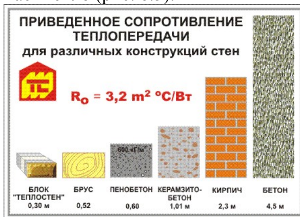
Рис. 6.5. Приведенное сопротивление теплопередачи для различных конструкций стен
