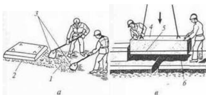
Рис. 2. Установка сборных элементов фундаментов: а – подготовка песчаного основания;
