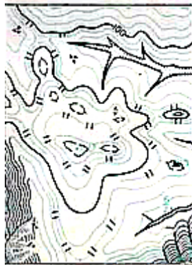
3. Вычерчивание утолщенных горизонталей и разметка звеньев и промежутков полугоризонталей
