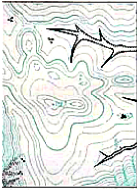
1. Вычерчивание элементов рельефа, не выражающихся горизонталями
