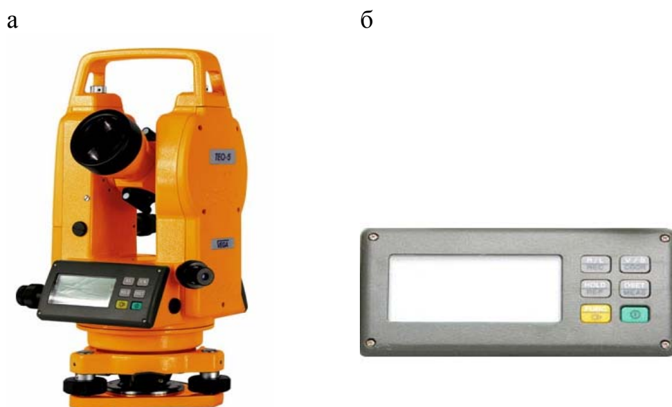
Рис. 88. Электронный теодолит Vega TEO-5: а – общий вид; б – панель управления
