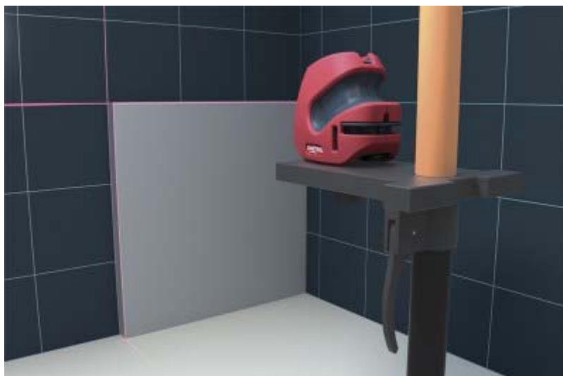
Рис.108. Лазерный нивелир «Condrol MicroX» проецирует классический крест
