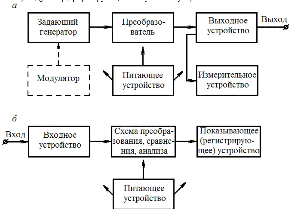
Рис. 1. Обобщенные функциональные схемы измерительных генераторов и приборов для измерения параметров и характеристик сигналов
