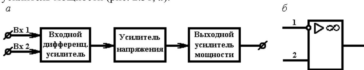
Рис. 2.31. Структурная схема интегрального операционного усилителя (а); условное обозначение операционного усилителя (б)
