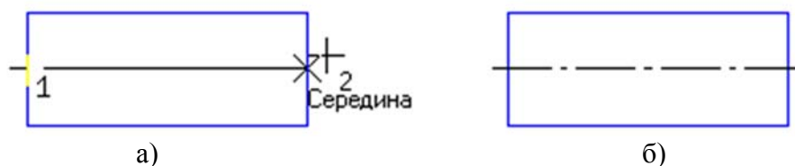
Рис. 184. Построение осевой линии по двум точкам: а – указание точек; б – результат построения
