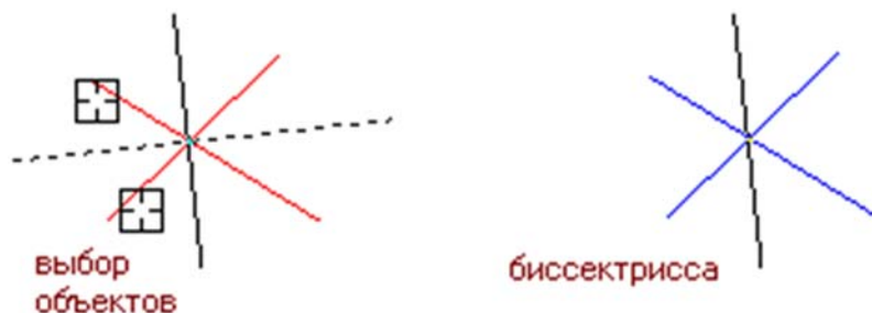
Рис. 73. Построение биссектрисы угла
