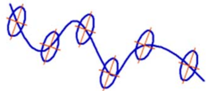
Рис. 112. Копирование объекта: а – с сохранением угла поворота и масштаба; б – с изменением угла поворота и масштаба
