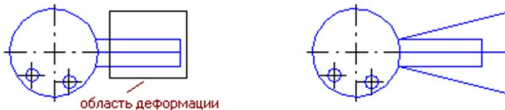
Рис. 119. Исходное изображение и изображение после деформации масштабированием (коэффициенты масштабирования по осям разные)
