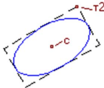
Рис. 96. Построение эллипса по центру и вершине габаритного прямоугольника
