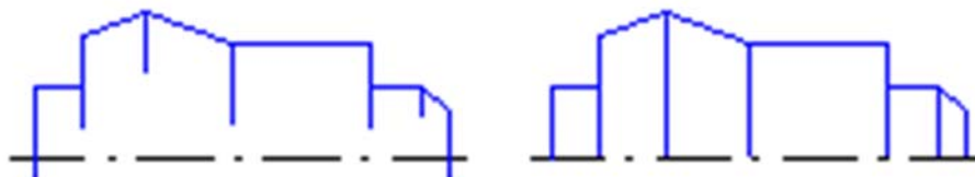
Рис. 122. Исходное изображение детали и изображение после выравнивания ребер по оси вращения
