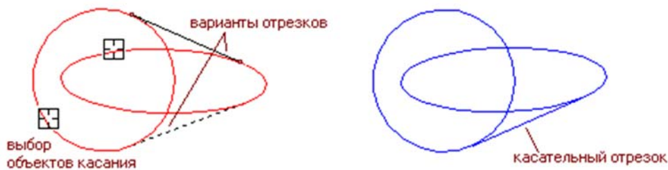
Рис. 30. Построение отрезка, касательного к двум кривым
