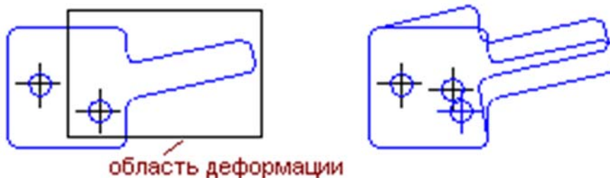
Рис. 117. Исходное изображение и изображение после деформации сдвигом
