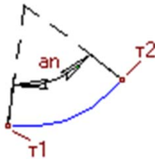
Рис. 55. Построение дуги по двум точкам и углу раствора
