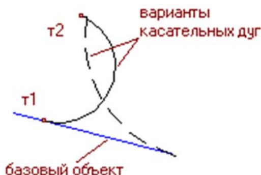
Рис. 54. Построение дуги, касательной к отрезку
