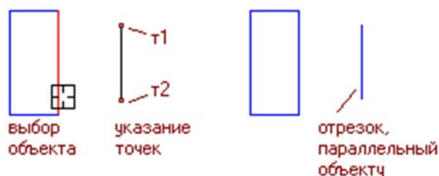
Рис. 22. Построение отрезка параллельно заданному объекту
