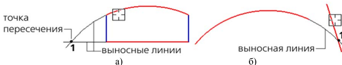
Рис. 187. Условное пересечение: а – для продолжений двух объектов; б – для объекта и продолжения другого объекта
