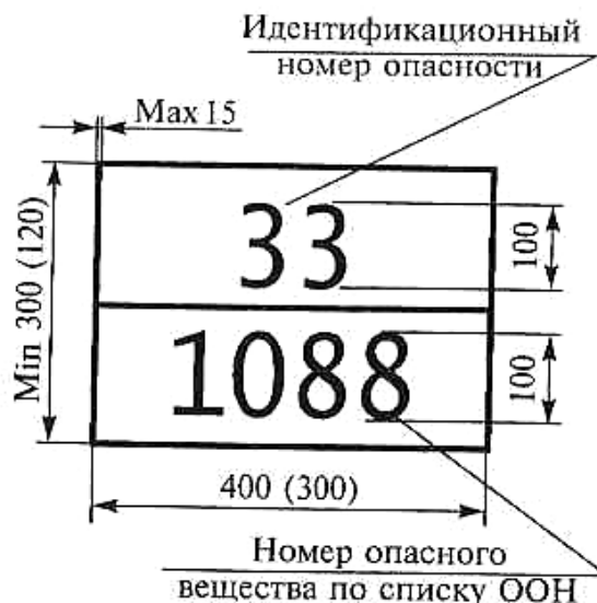
Рис. 5.3. Информационная табличка автотранспортного средства, перевозящего опасные грузы в международном сообщении
