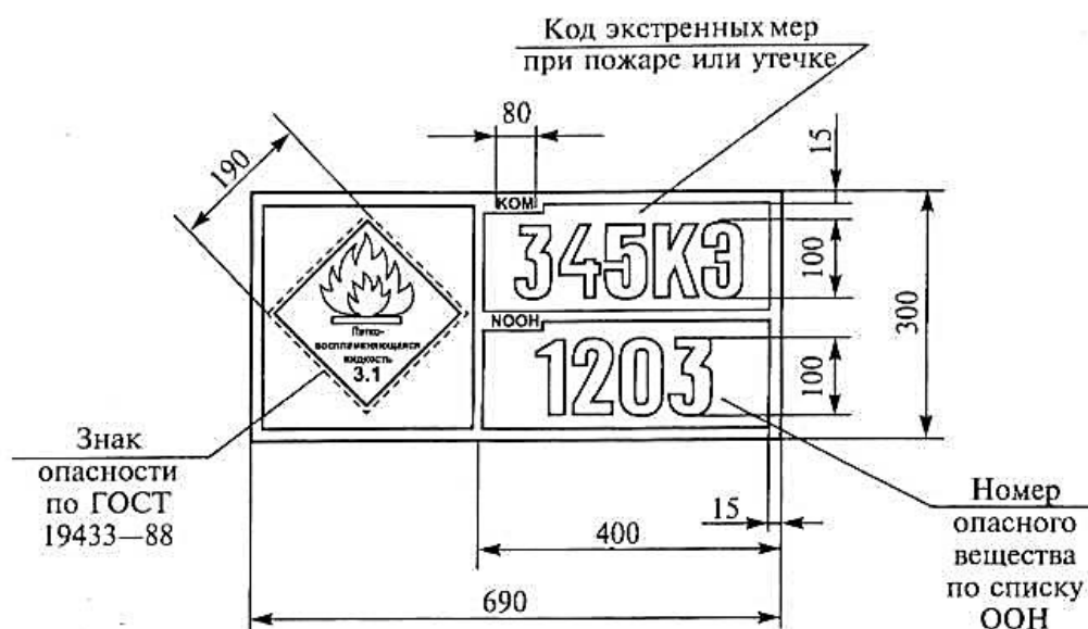
Рис. 5.2. Информационная табличка транспортного средства, перевозящего опасные грузы во внутреннем сообщении
