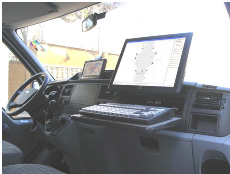
Рис. 4.16. Система фиксации характерных точек и объектов с программируемой клавиатурой
