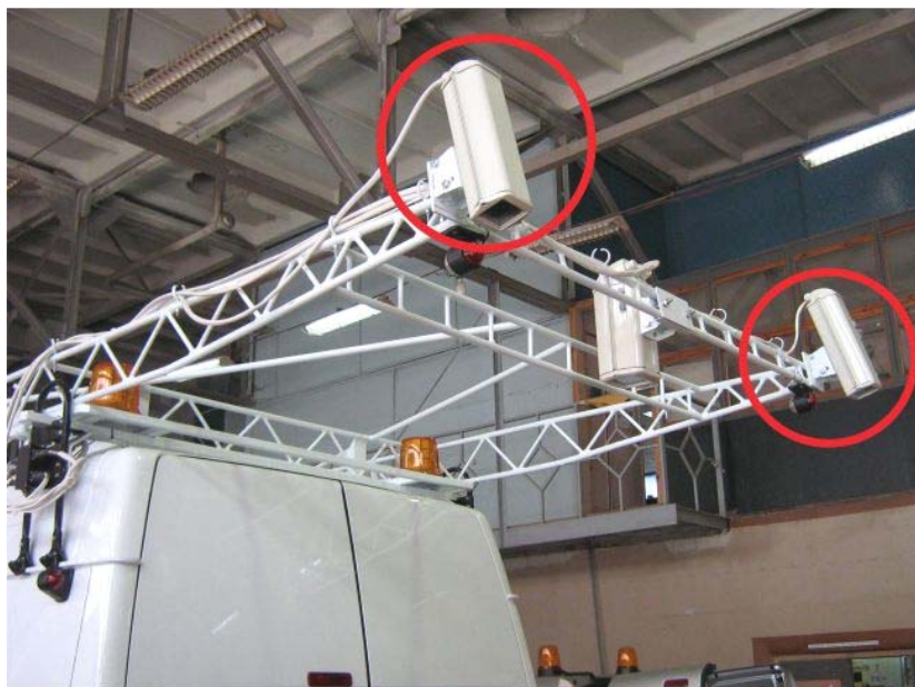
Рис. 4.15. Система измерения параметров поперечной ровности по лазерному лучу
