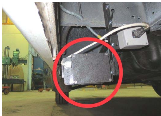
Рис. 4.12. Расположение лазерных датчиков под днищем кузова лаборатории
