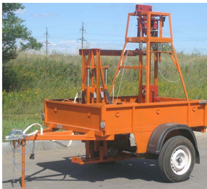
Рис. 4.17. Система измерения прочности дорожных одежд «Дина-3М».
