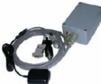
Рис. 2.4. Устройство для измерения геометрии – малогабаритная интегрированная инерциальная навигационная (МИНС) система КомпНав-2Т
