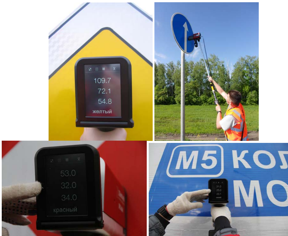
Рис. 5.6 Процесс измерения коэффициента световозвращения дорожных знаков прибором-ретрорефлектометром
