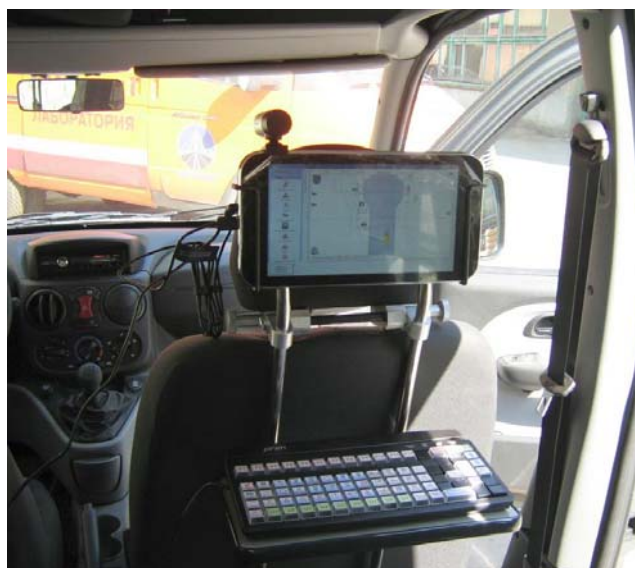
Рис. 5.9. Система оценки состояния инженерных сооружений
