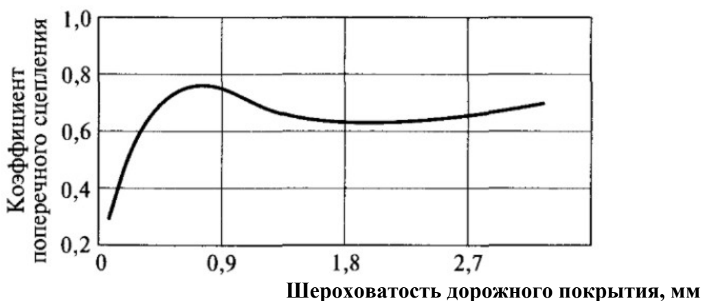
Рис. 4.3. Зависимость коэффициента поперечного сцепления от шероховатости дорожного покрытия
