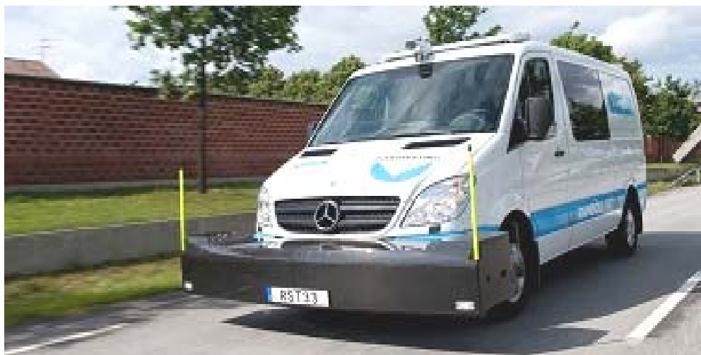
Рис. 4.18. Измерение колеиности в поперечном направлении
