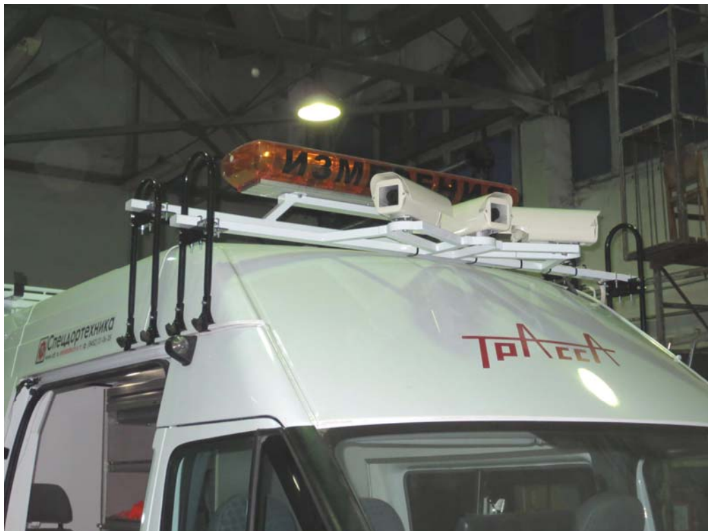
Рис. 2.3. Лаборатория для проведения измерений параметров дороги «Трасса»
