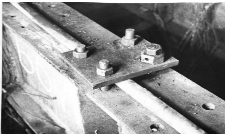
Рис. 2.3. Крепление цилиндрического рельса к модели балки (Пенза)
