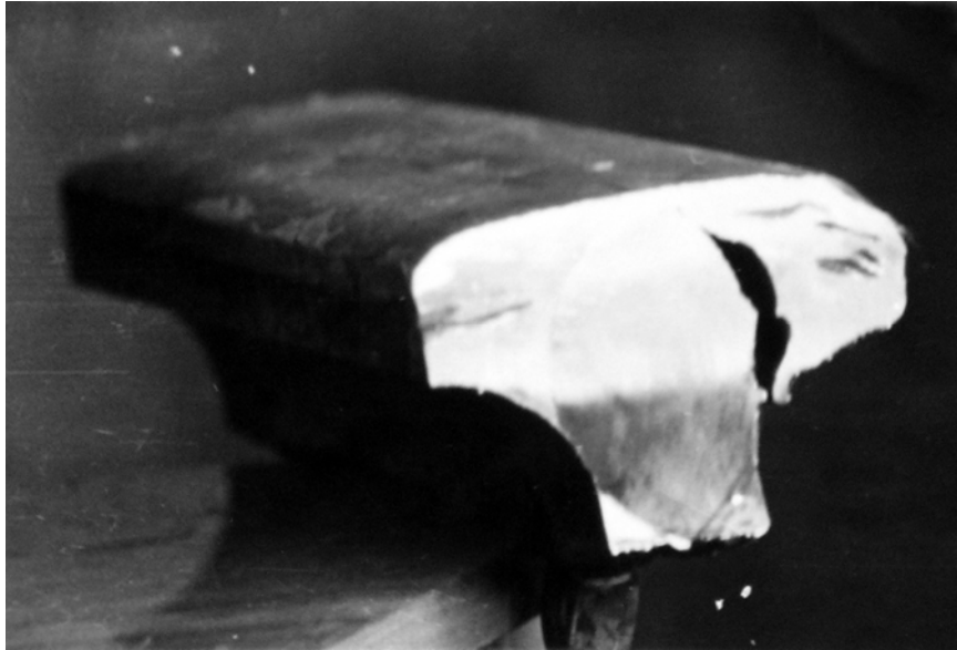
Рис. 1.10 Аварийная усталостная трещина в главе рельса
