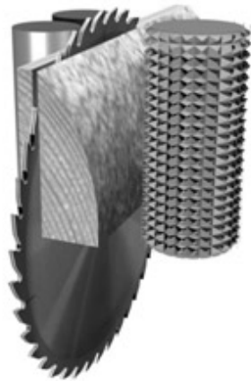
Рис. 32. Схема работы реброво-горбыльного станка: а – вертикального, б – горизонтального
