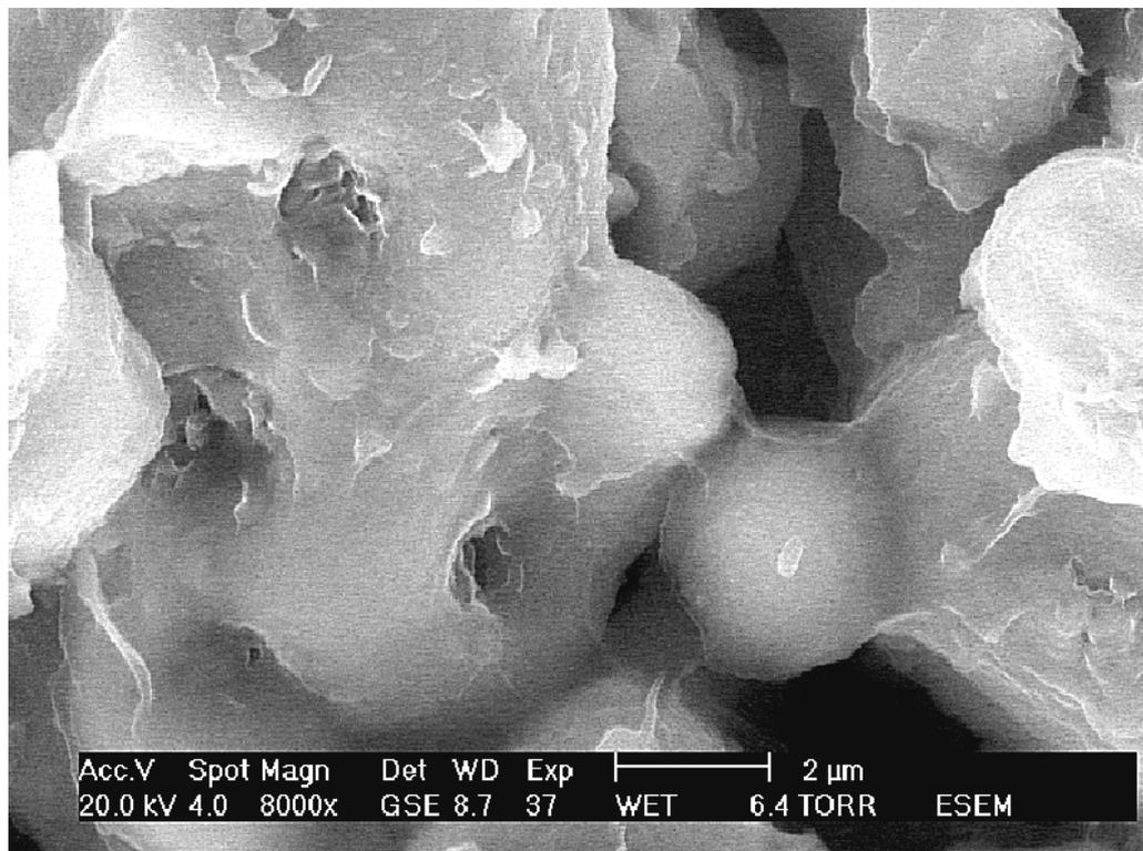
Рис. 2.2. Образование гелевидной оболочки вокруг  $C_3S$  через 5 минут после начала гидратации<sup>1</sup>
