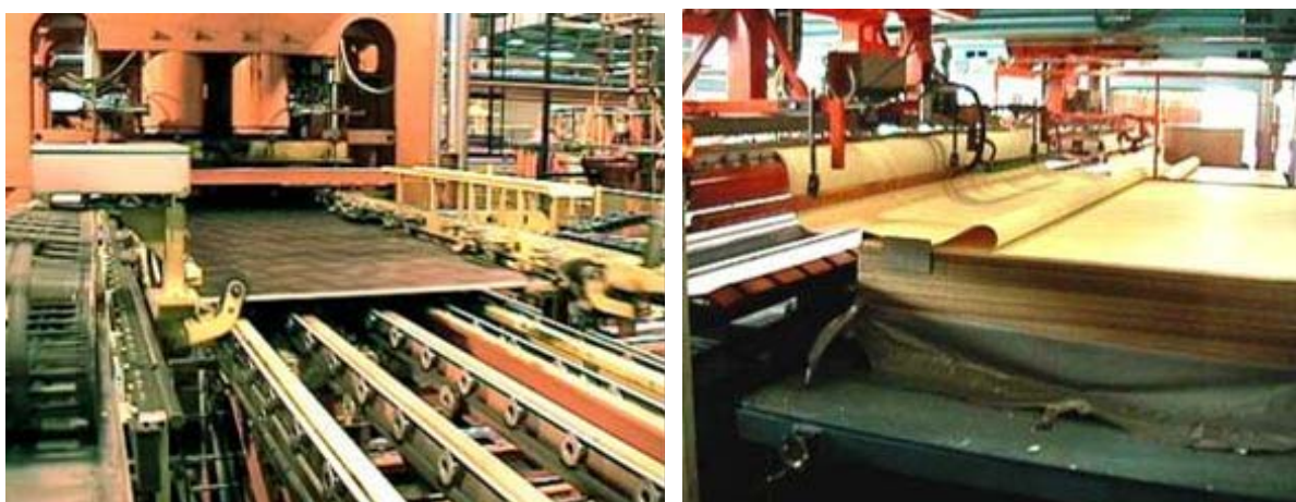
Рис. 6.42. Линия ламинирования с составляющими этой линии: а – линия быстрого ламинирования; б – подача плиты в пресс; в – мультивакуумное устройство с переворотной планкой для укладки пленки
