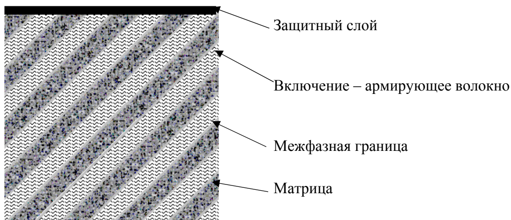
Рис. 2. Основные компоненты композиционных материалов
