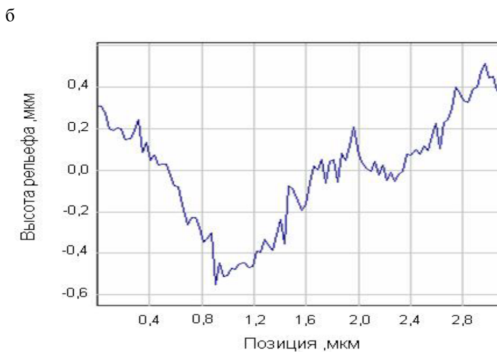
Рис. 2.11. АСМ-изображение поверхности диатомита, активированного гидроксидом натрия в соотношении 1:0,2 (а) и рельефа поверхности (б), построенного вдоль соответствующей линии
