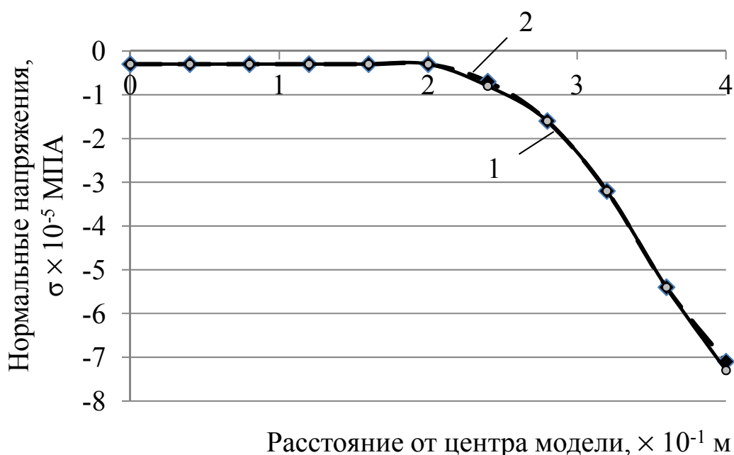
Рис. 4.45. Нормальные напряжения в зоне контакта штукатурки с отделяемым покрытием по линии 1-7: 1 – по оси X \sigma_x ; 2 – по оси Z \sigma_z
