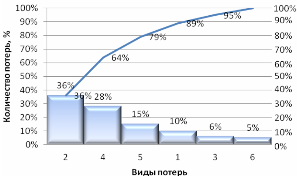
Рис. 2.4. Виды потерь сахара-песка из-за оборудования: 1 – потери из-за несовершенства типа оборудования; 2 – потери за счет изношенности оборудования; 3 – потери из-за несовершенства контроля за оборудованием; 4 – потери из-за неправильной эксплуатации; 5 – потери за счет неправильно выбранных режимов; 6 – прочие причины
