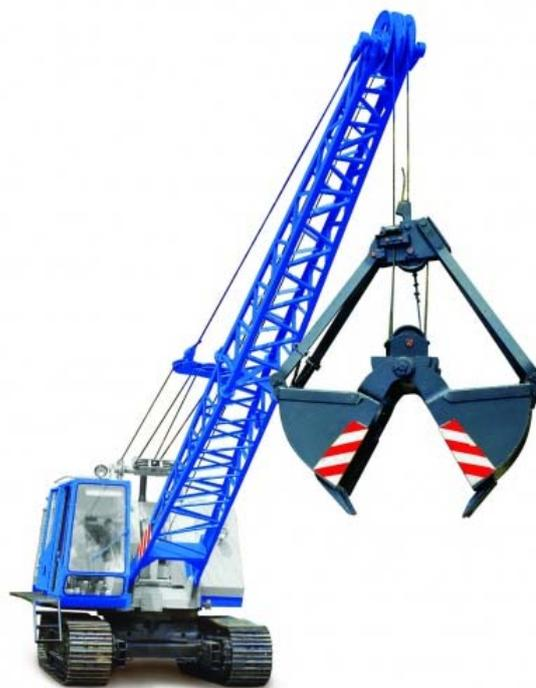
Рис.14. Экскаватор с грейферным ковшом
