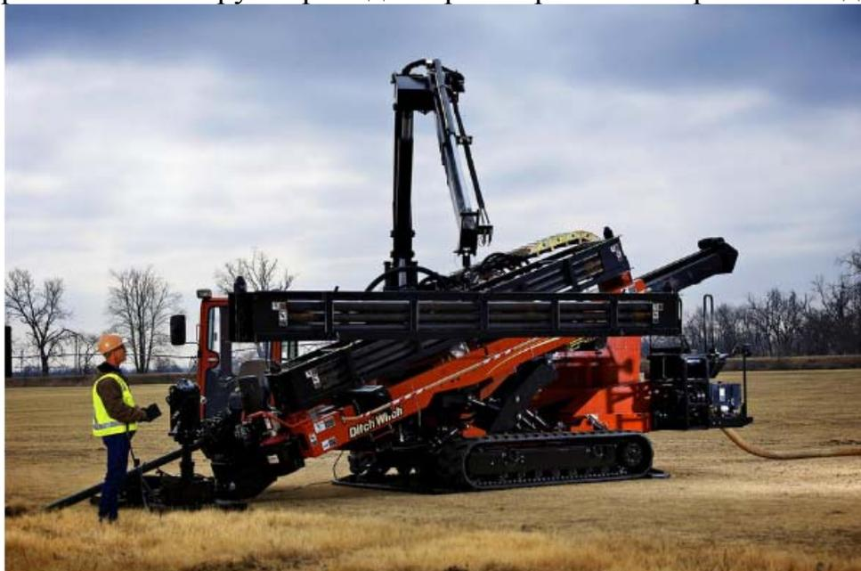
Рис.29. Установка горизонтально направленного бурения Ditch Witch JT100 All Terrain
