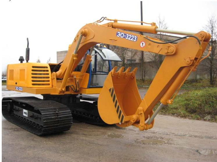
Рис.10. Экскаватор с обратной лопатой
