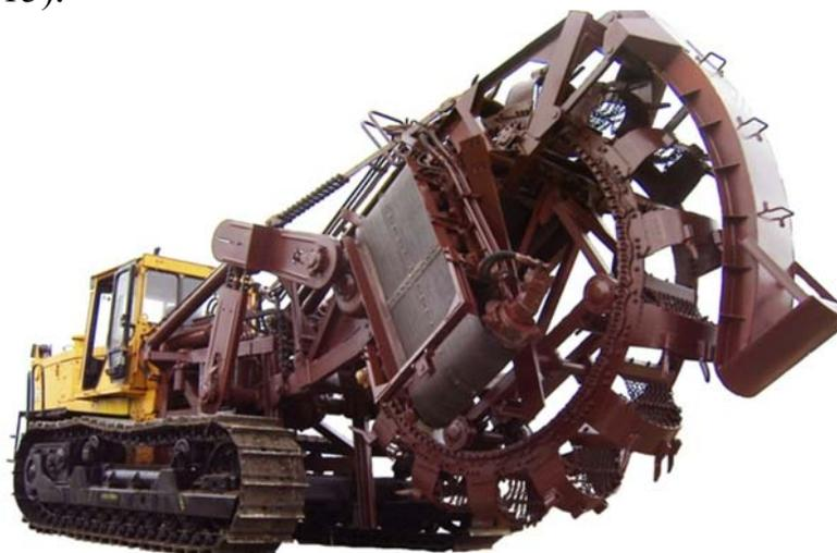
Рис.15. Роторный многоковшовый экскаватор
