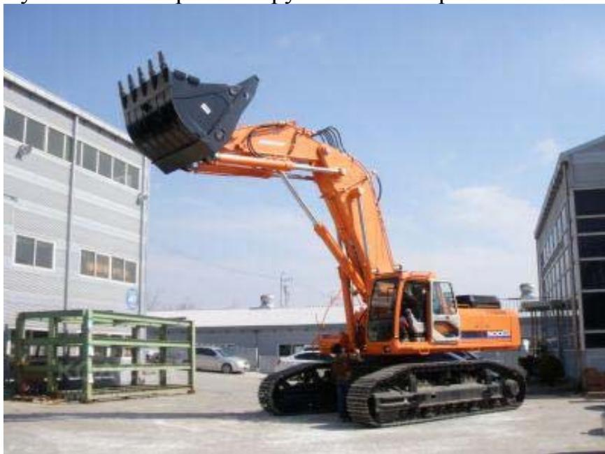
Рис.9. Экскаватор с прямой лопатой
