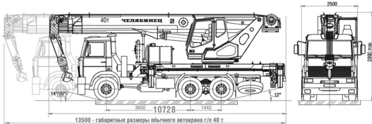
Автокран КС-65711-27 «ЧЕЛЯБИНЕЦ» – это модель из обновленной серии автомобильных кранов 2010 года грузоподъемностью 40 тонн на шасси КАМАЗ-6520 (6х4).
