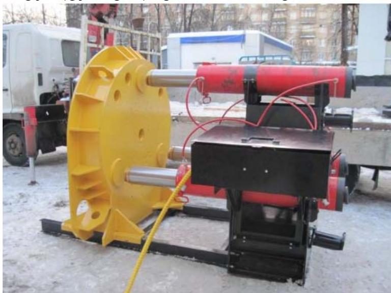
Рис.28. Установка для продавливания труб
