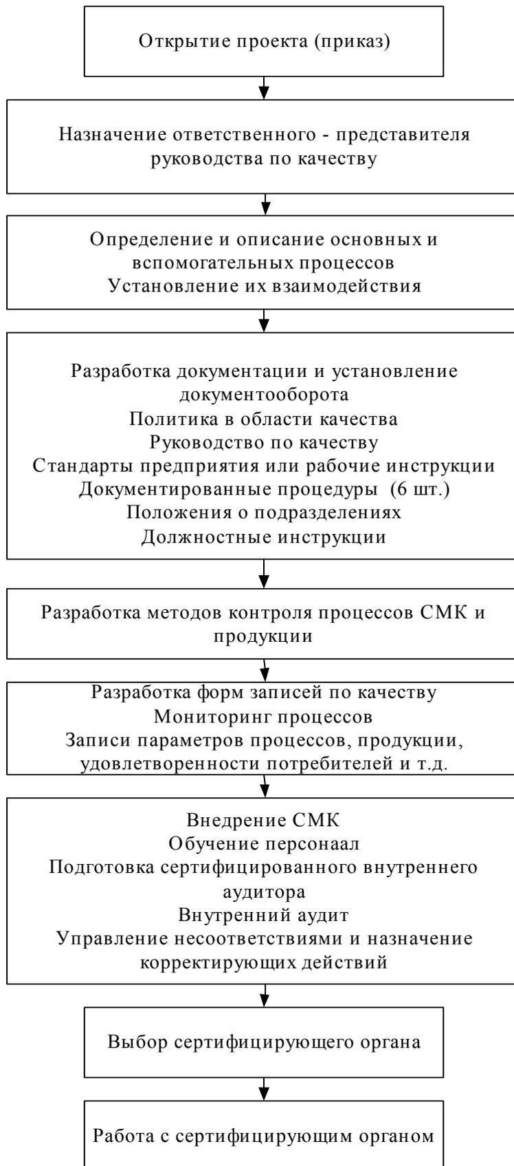
Рис. 3.2. Последовательность проведения работ по созданию СМК
