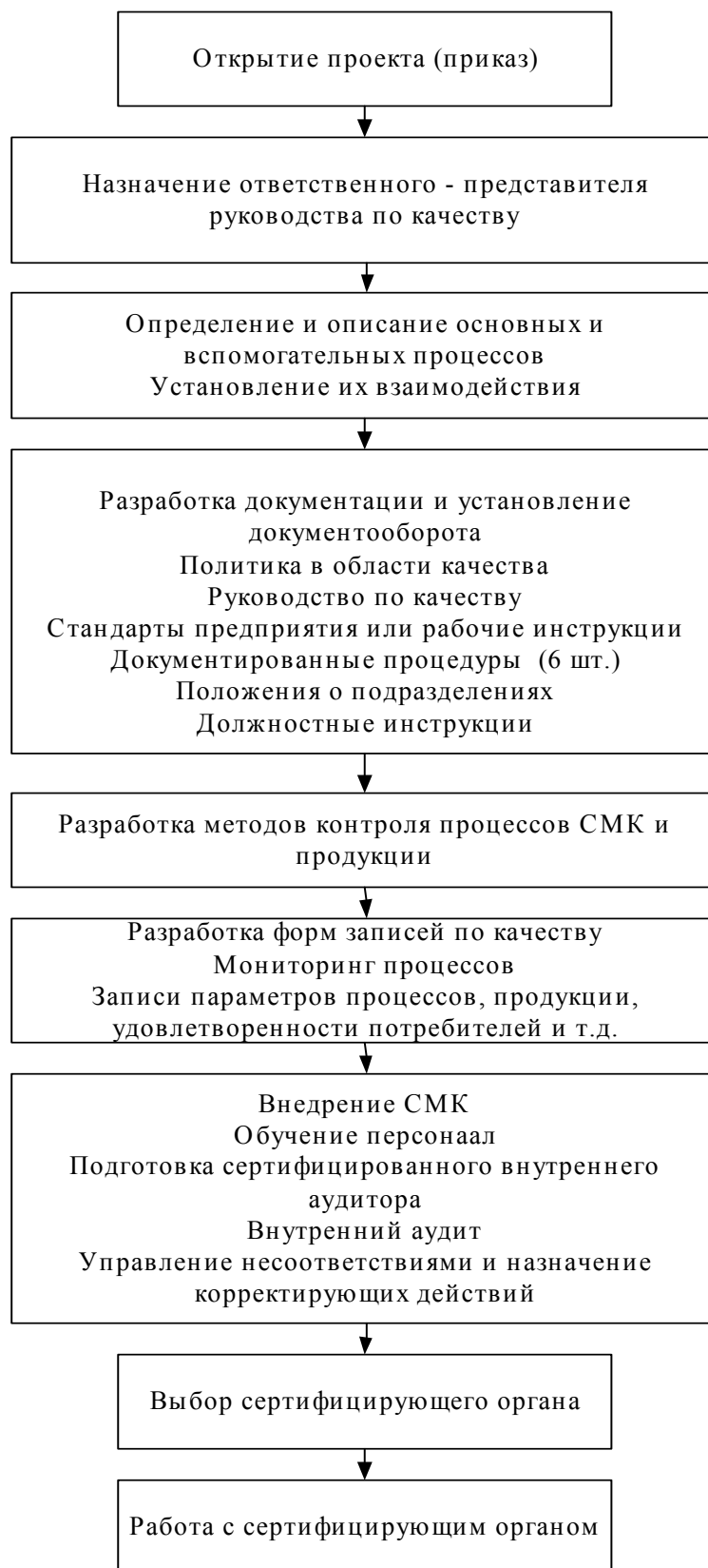
Рис. 3.6. Последовательность проведения работ по созданию СМК
