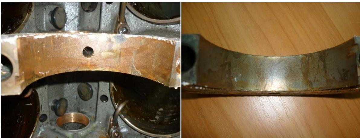
Рис. 5.27. Внешний вид покрытия электролитического железа, осажденного на опоры блока цилиндров
