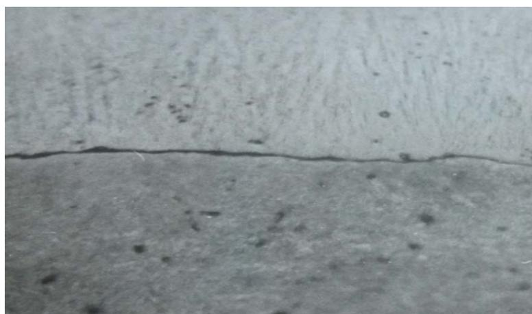
Рис. 4.13. Микроструктуры электролитического железа, полученного при плотностях тока 8...10 А / дм<sup>2</sup>
