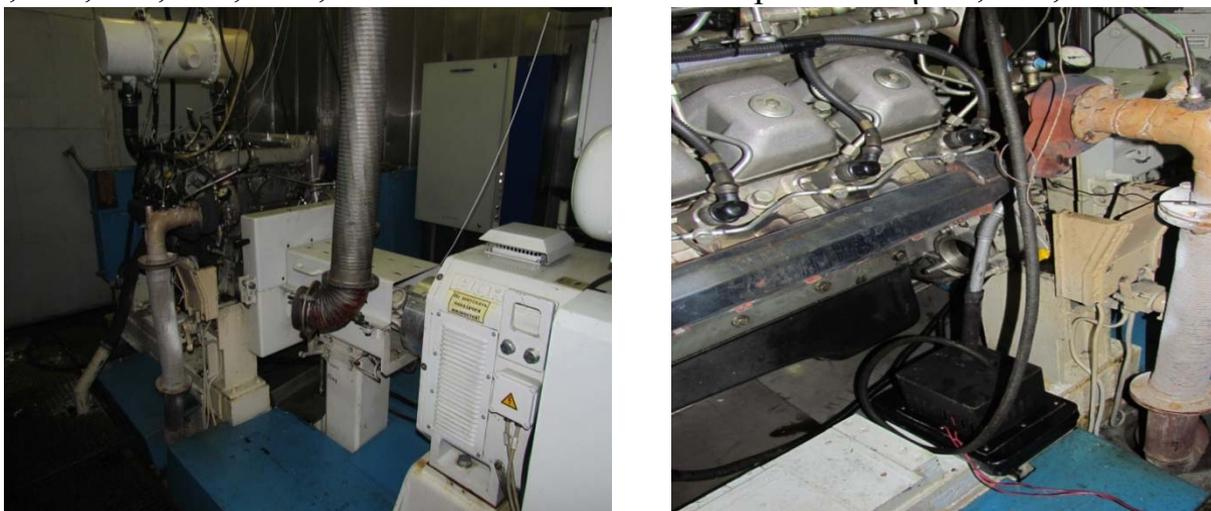
Рис. 2.8. Испытания автономной системы смазки турбокомпрессоров на стенде HORIBA
