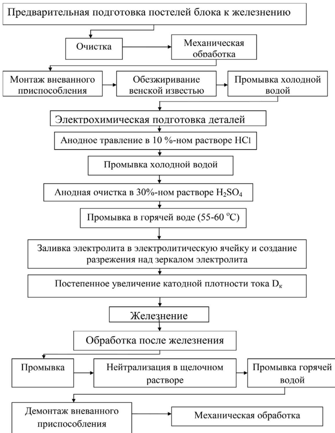
Рис. 5.24. Схема технологического процесса вневанного железнения опор блока цилиндров двигателя КамАЗ
