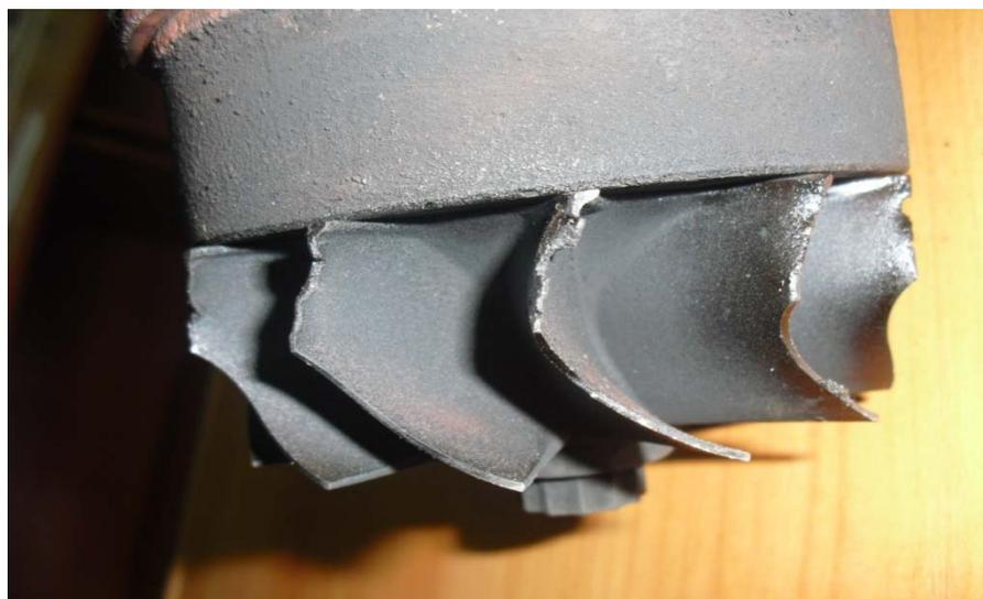
Рис. 1.22. Повреждения лопаток турбинного колеса
