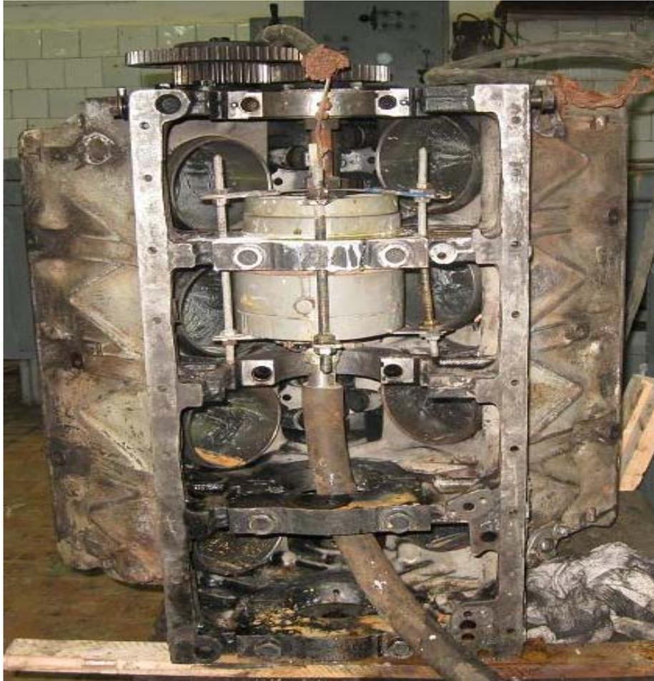
Рис. 5.26. Внешний вид электролитической ячейки при осаждении электролитического железа на опоры блока цилиндров
