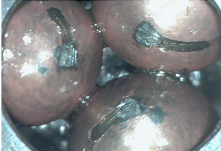
Рис. 5.34. Поверхность шариков после схватывания
