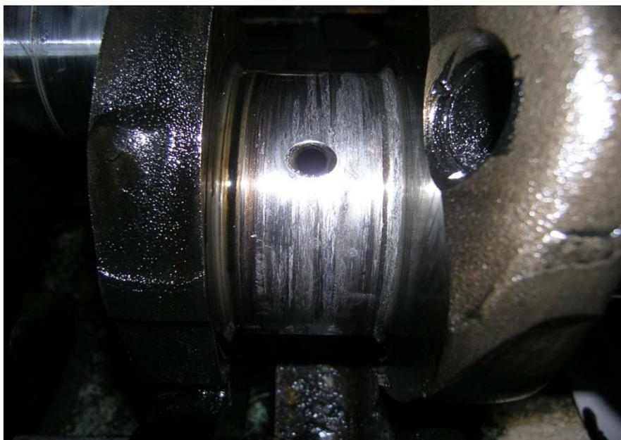
Рис. 1.11. Задирь на шейке вала, результат схватывания с вкладышем
