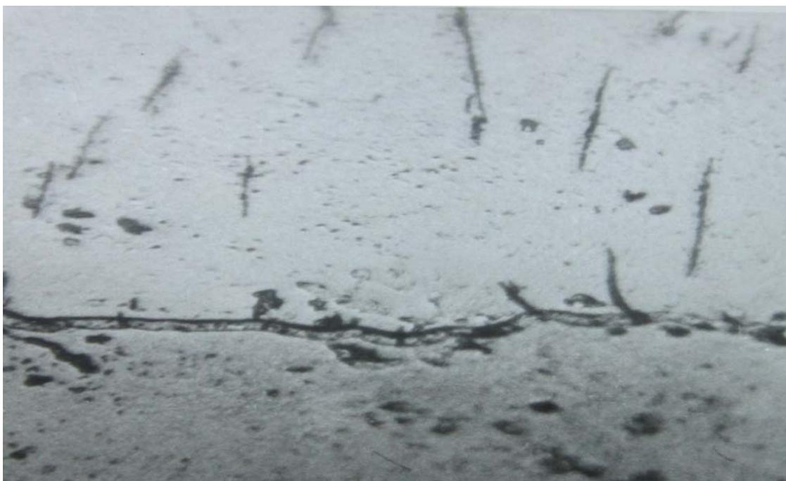
Рис. 4.10. Включения гидроокиси в слои за счет защелачивания прикатодного слоя
