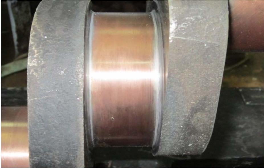
Рис. 5. 30. Внешний вид металлоплакирующего покрытия меди на шейке вала
