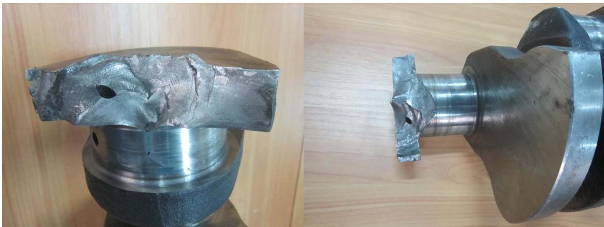
Рис. 3.15. Усталостное разрушение коленчатого вала
