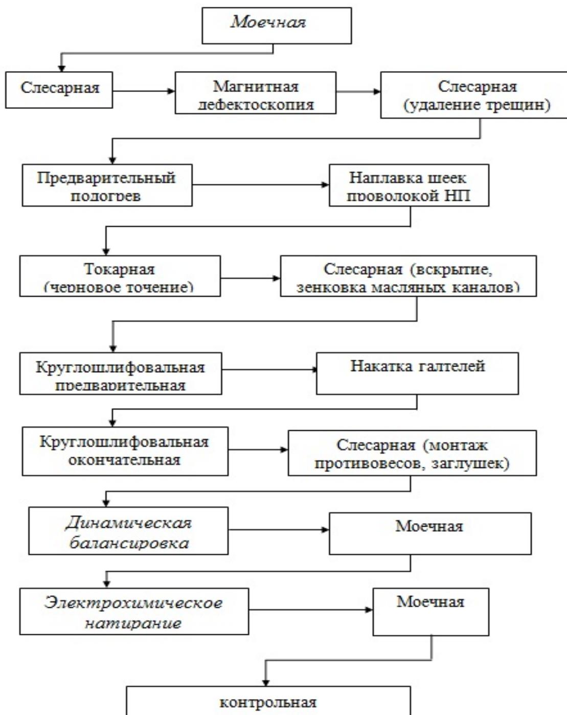
Рис. 5.29. Схема технологического процесса восстановления коленчатых валов двигателя КамАЗ
