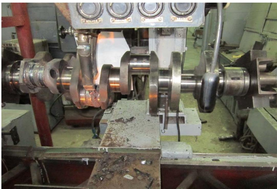
Рис. 5.28. Наплавка шеек коленчатого вала КамАЗ–740
