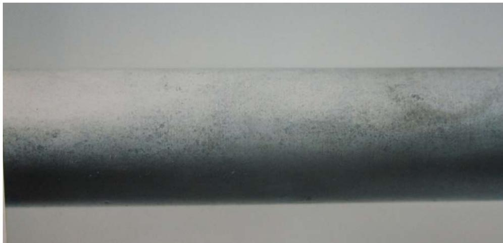
Рис. 4.27. Образец, полученный при железнении с созданием разрежения над зеркалом электролита
