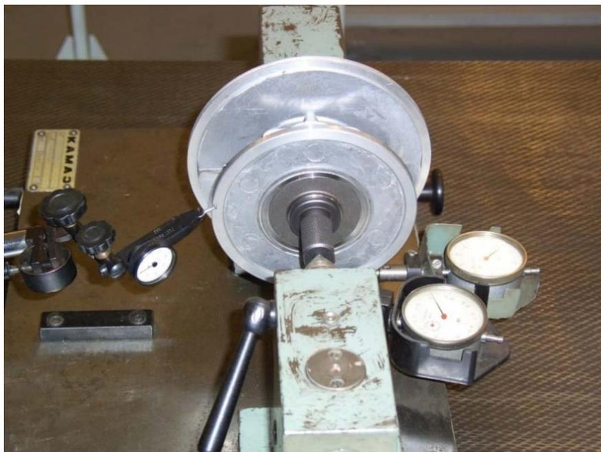
Рис. 2.5. Установка для измерения биений поверхностей корпуса подшипников
