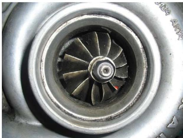
Рис. 1.23. Повреждения турбинного колеса из-за касания о корпус, обусловлено большим зазором в подшипнике
