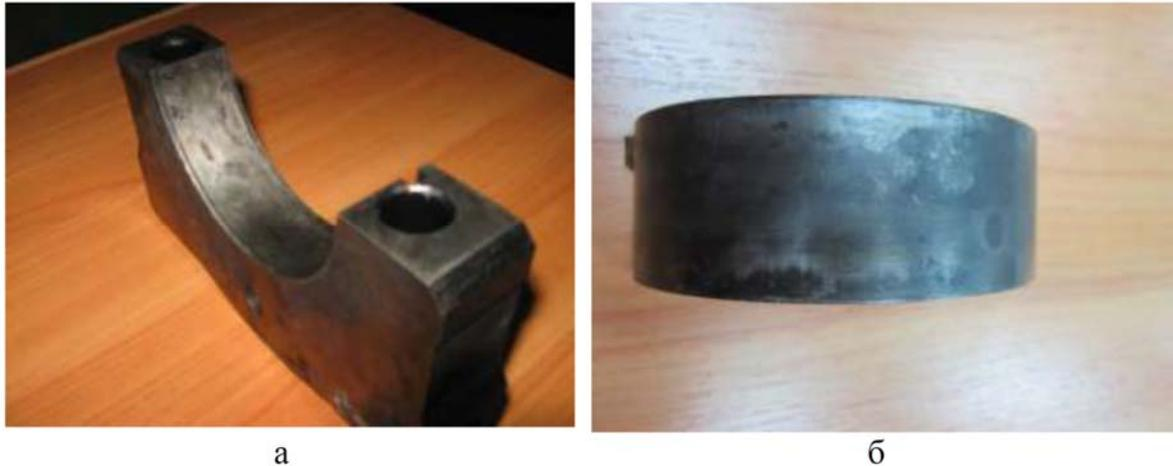
Рис. 3.24. Фреттинг-изнашивание на крышке коренной опоры (а) и на обратной стороне коренного вкладыша (б)
