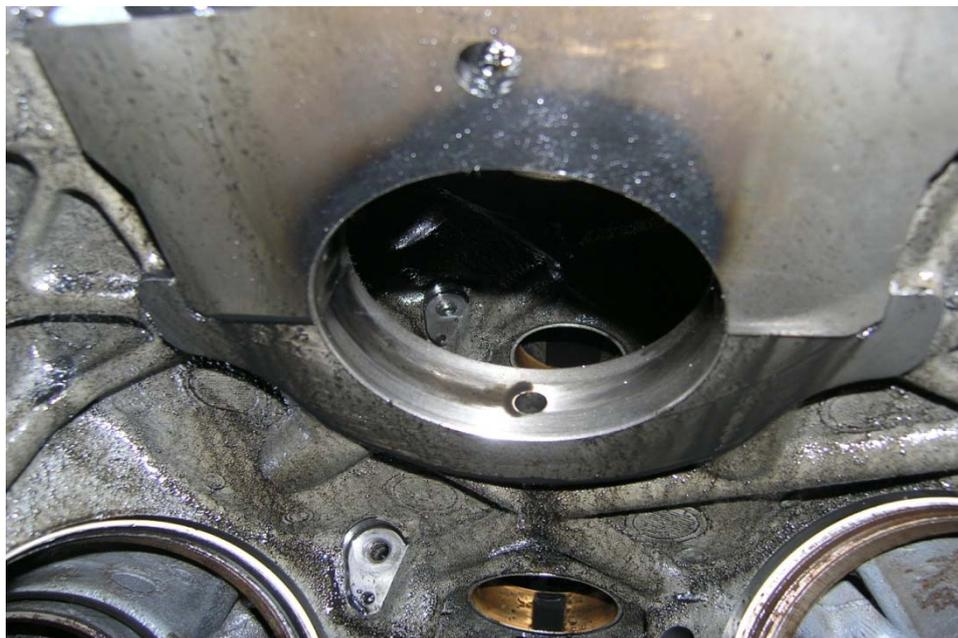
Рис. 1.14. Износ постели блока в результате перегрева сопряжения и проворачивания коренного подшипника
