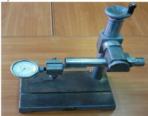
Рис. 2.3. Приспособление для определения прогиба стержня шатуна и корсетности нижней головки шатуна (внешний вид)
