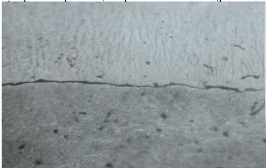
Рис. 4.3. Структура покрытия электролитического железа, полученного в проточном электролите
