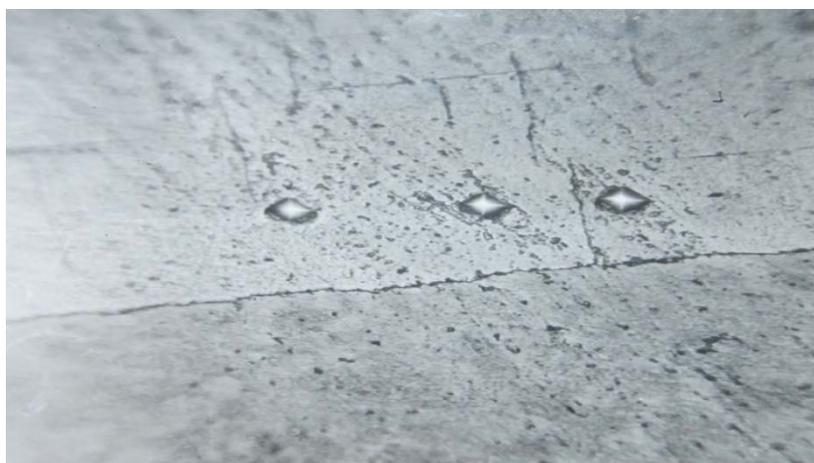
Рис. 4.14. Трещины в покрытии электролитического железа
