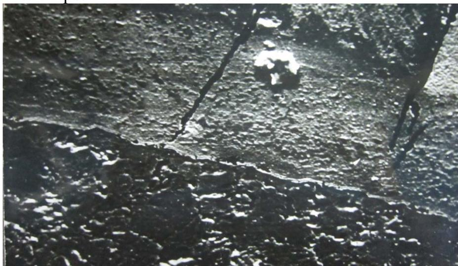
Рис. 4.4. Появление трещин в покрытиях железа
