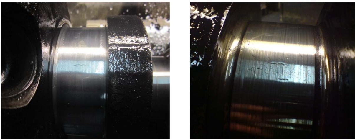
Рис. 1.12. Усталостные трещины на шейке вала
