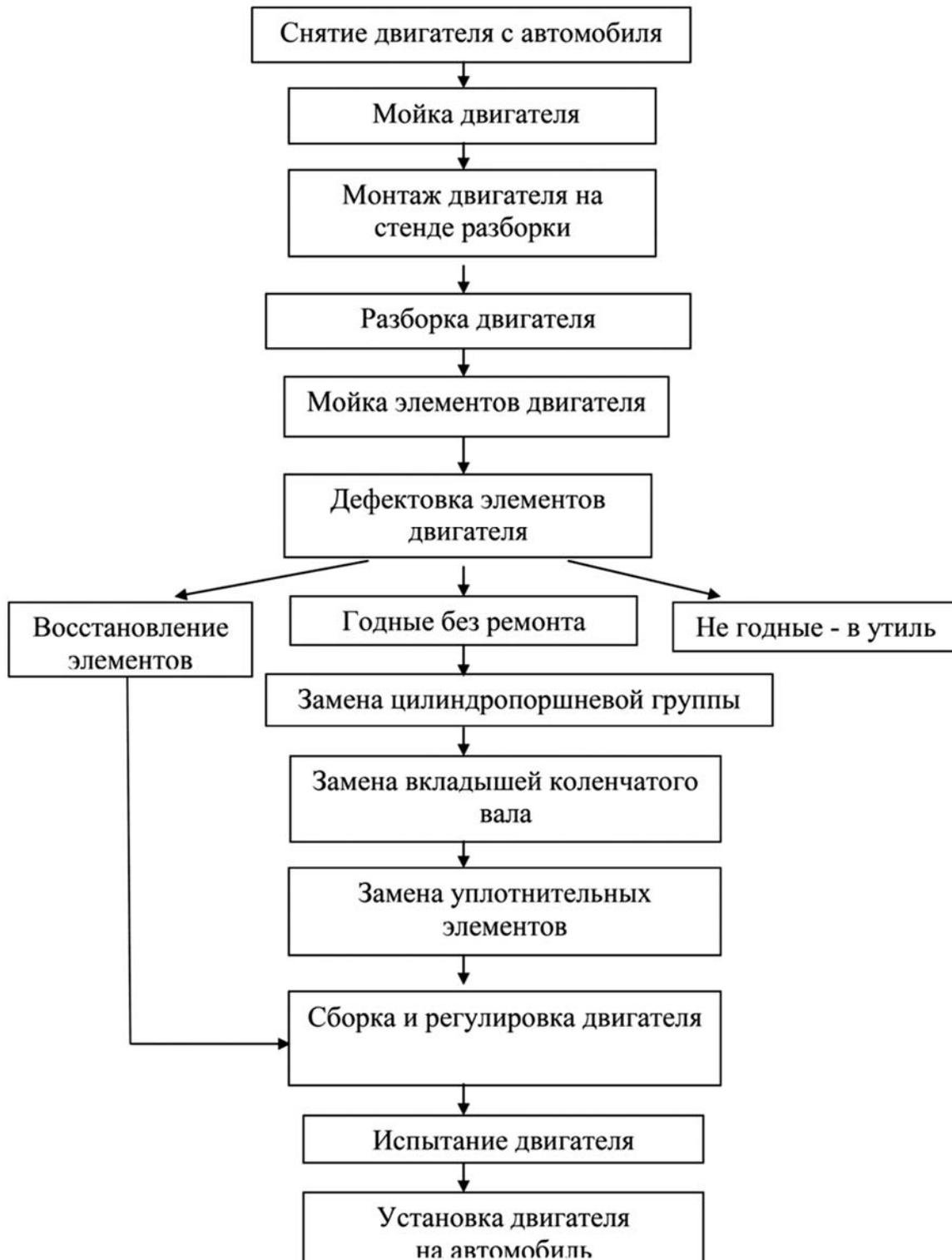
Рис. 6.2. Схема ремонта двигателя КамАЗ-Евро
